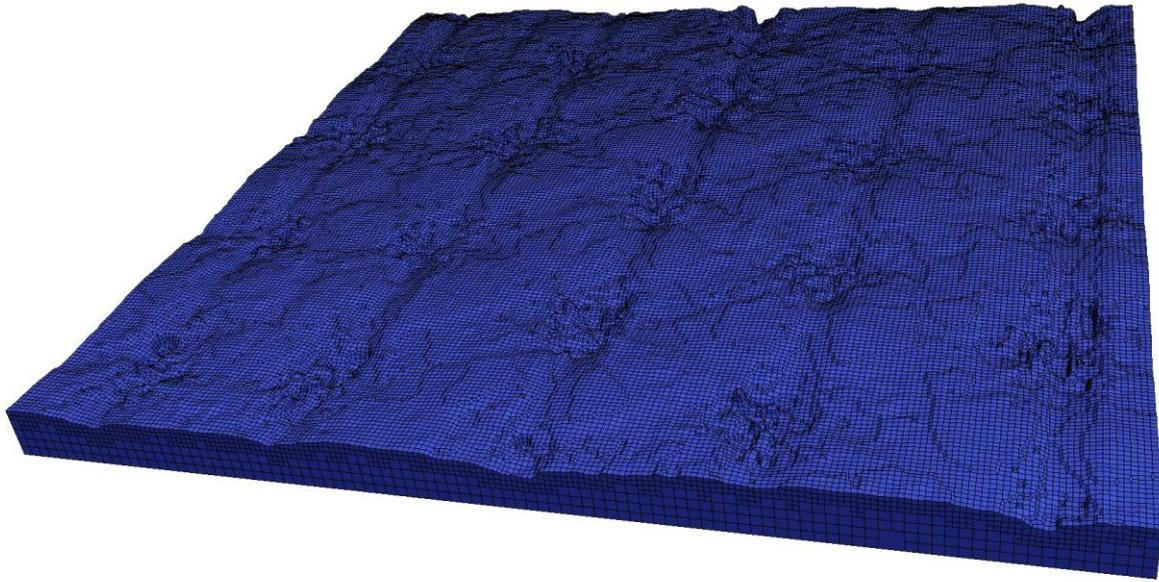
Abbildung 125: Isometrische Darstellung der vernetzten Festkörperoberfläche von Feld 4
