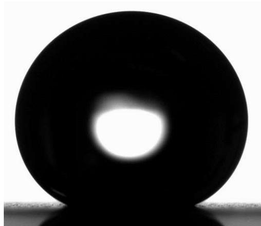
Abbildung 109: Wassertropfen auf beschichtetem Feld 3 (Messung 2)
