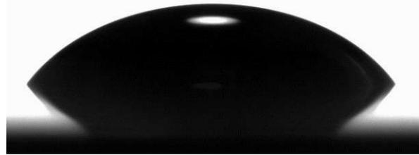
Abbildung 46: Diiodmethantropfen auf der Aluminiumoberfläche (Messung 2)
