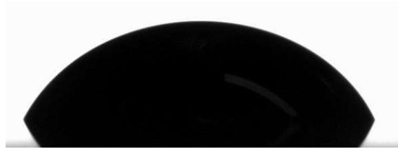
Abbildung 112: Diiodmethantropfen auf beschichtetem Feld 1 (Messung 1)
