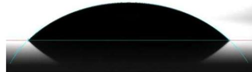
Abbildung 43: Wassertropfen auf der Glasoberfläche (Messung 3)
