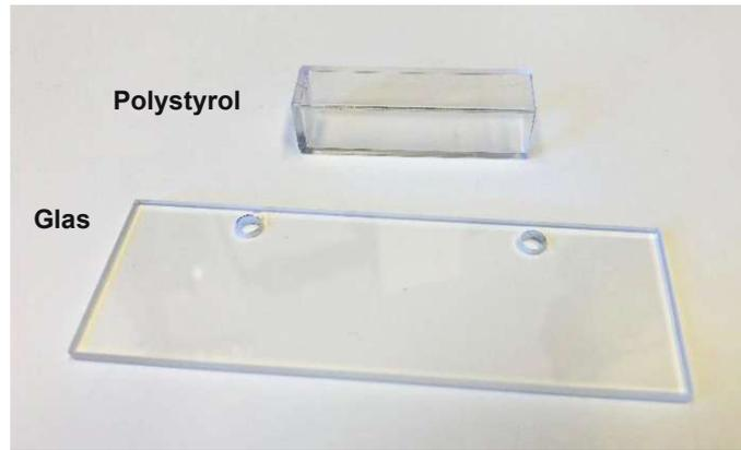
Abbildung 36: Einmal-Küvette aus Polystyrol (oben); Glasplatte (unten)
