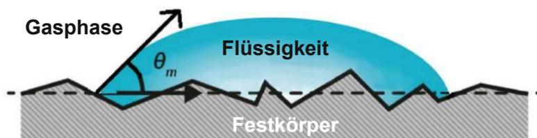
Abbildung 11: Schematische Darstellung des gemessenen makroskopischen Kontaktwinkels  $\theta_m$  auf einer strukturierten Oberfläche im Wenzel-Zustand [41]
