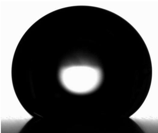
Abbildung 108: Wassertropfen auf beschichtetem Feld 2 (Messung 1)
