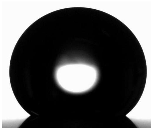
Abbildung 110: Wassertropfen auf beschichtetem Feld 4 (Messung 2)
