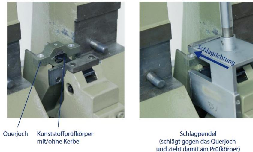
Abbildung 22: Schlagzugversuch [8]
