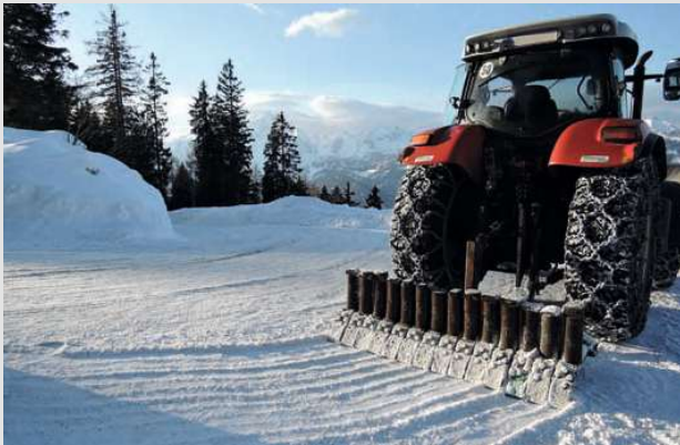
Bild 3: Feldversuch Verschleiß der Räumleistensegmente
