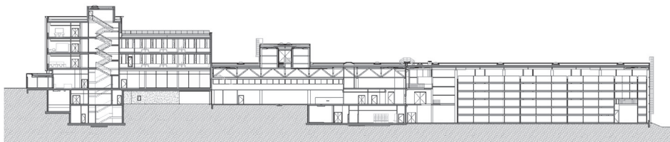
Abb. 5: unten: Gebäudeschnitt: Von der Produktentwicklung zur Produktion bis zum Versand © ATP
