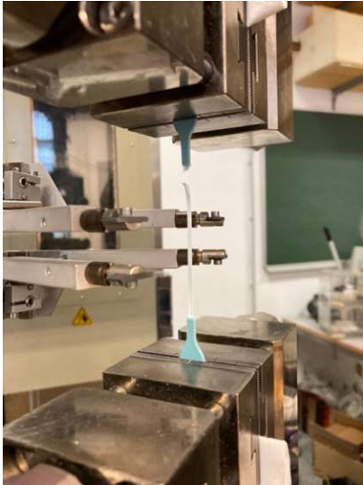
Abbildung 47 Fotografie während des Zugversuchs und der Spritzgussmaschine (a) Ausgangsposition – Zugversuch; (b) Dehnung – Zugversuch; (c) Probenbruch – Zugversuch; (d) HAAKE MiniJet II Spritzgussmaschine
