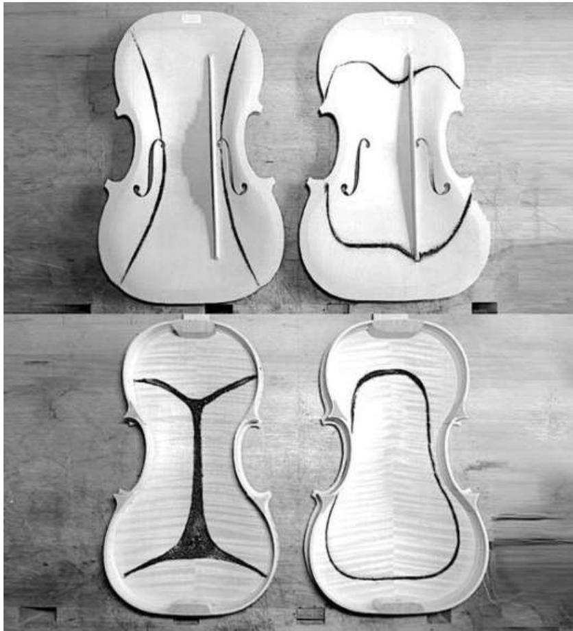
Abb. 38: Knotenlinien aus Sand, Verwendung im Geigenbau
