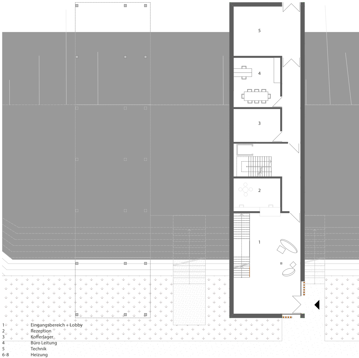
Abb. 108 Grundriss Erdgeschoss, Gästehaus
