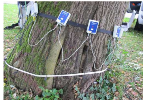
Abb. 20 Schalltomographie am Stamm eines schadhaften Baumes
