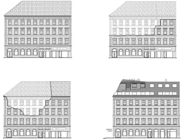
Abb. 4.3. Mariahilferstraße 182, Stadien des Wiederaufbaus
