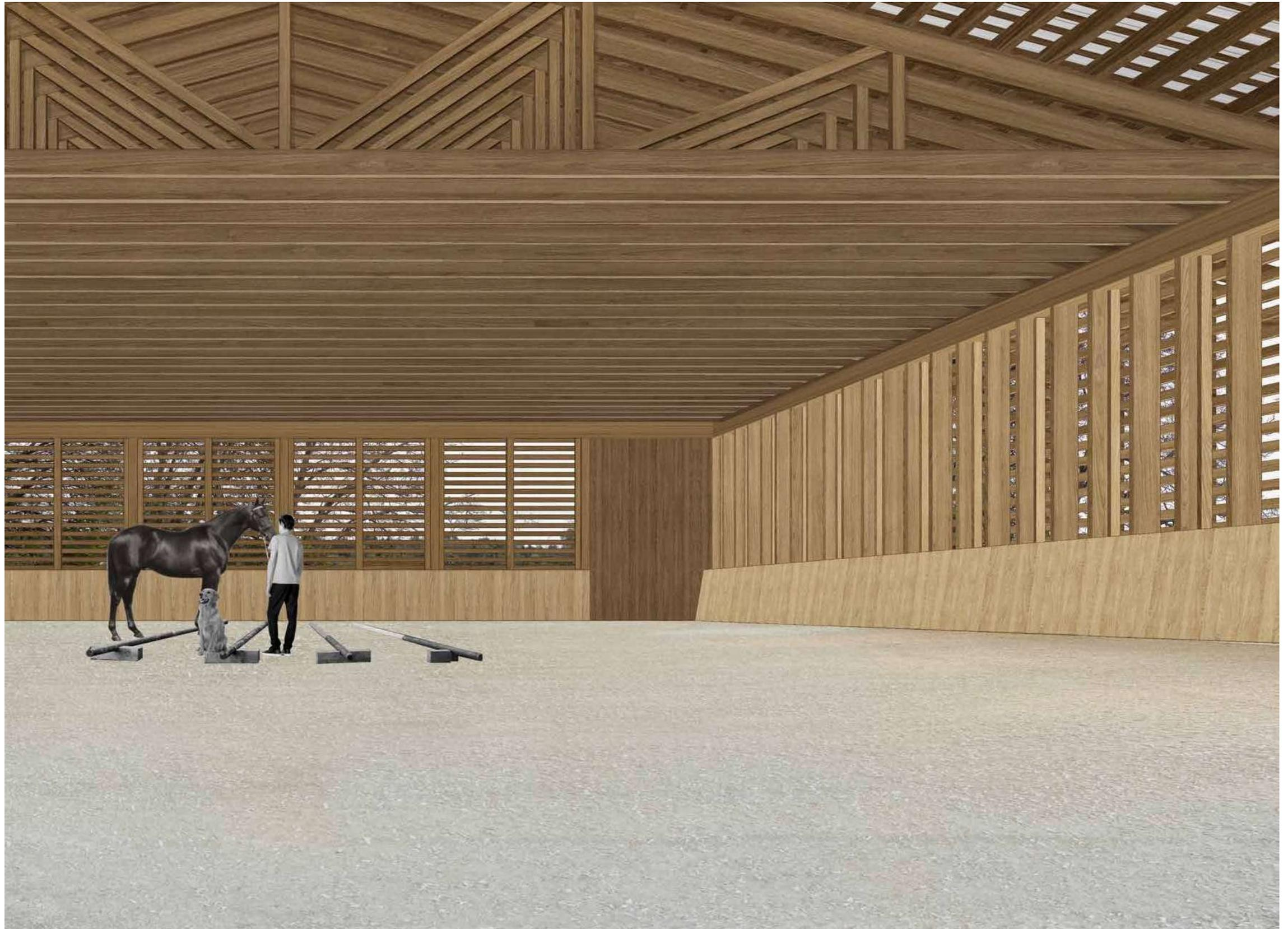
Die großen Festverglasungen in der Stallfassade sorgen für Tageslicht und bieten den Pferden den Ausblick ins Grüne. Zusätzliche Luftspalten gewährleisten, die ausreichende Frischluftzufuhr, ohne, dass die Pferde in der Zugluft stehen. Zwei Stalltüren ermöglichen den Pferden den ständigen Ausgang auf die angrenzenden Weideflächen. Der Dachüberstand dient hier als überdachter Außenbereich für die Pferde und für die temporäre Lagerung von Heu.
