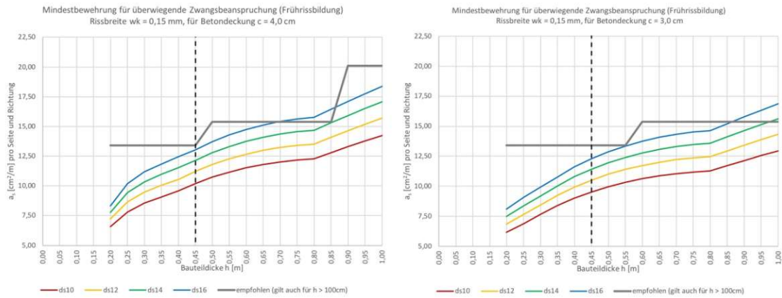
Abbildung 4.1 – Mindestbewehrung für überwiegende Zwangsbeanspruchung (Frührissbildung), Rissbreite w_k = 0,15 mm, für Betondeckungen c = 4,0 cm (links) und c = 3,0 cm (rechts) Darstellung nach [öbv-RL „Weiße Wannen“ (2018); S. 14 f. – Abbildung 4-5 und Abbildung 4-6]
