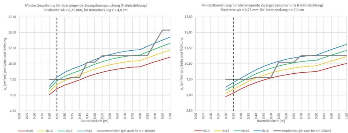
Abbildung 4.3 – Mindestbewehrung für überwiegende Zwangsbeanspruchung (Frührissbildung), Rissbreite w_k = 0,25 mm, für Betondeckungen c = 4,0 cm (links) und c = 3,0 cm (rechts) Darstellung nach [öbv-RL „Weiße Wannen“ (2018); S. 16 f. – Abbildung 4-9 und Abbildung 4-10]
