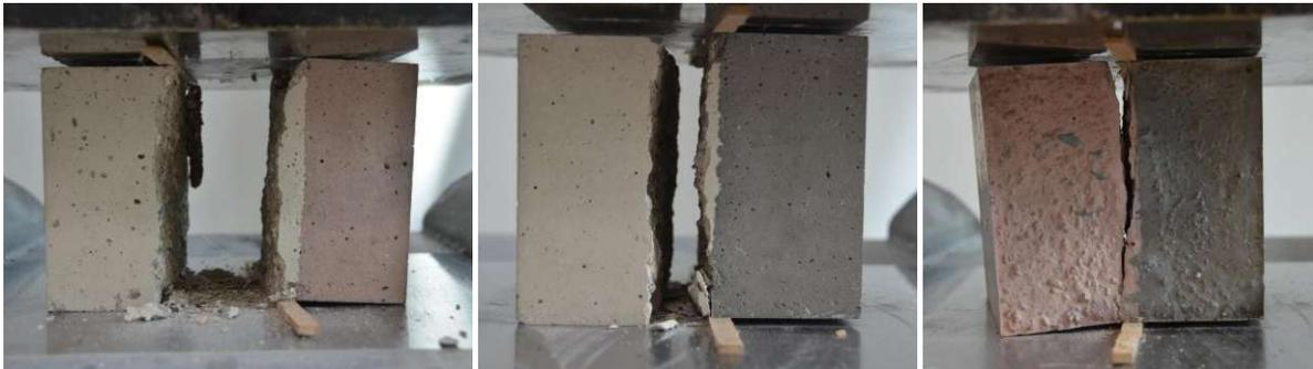
Abb. 4.9: Würfel nach Spaltzugversuch
