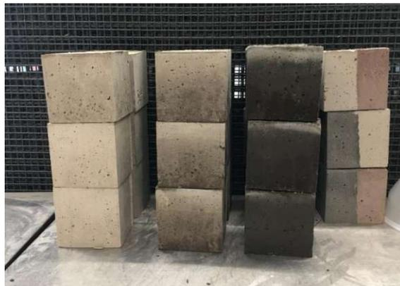
**Abb. 4.4:** ausgeschaltete Probewürfel von links nach rechts: „Low“, „Medium“, „High“, gradiert
