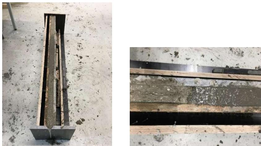
**Abb. 4.13:** Betonierter Steg in Schalung (rechts), vertikale Fuge (links)
