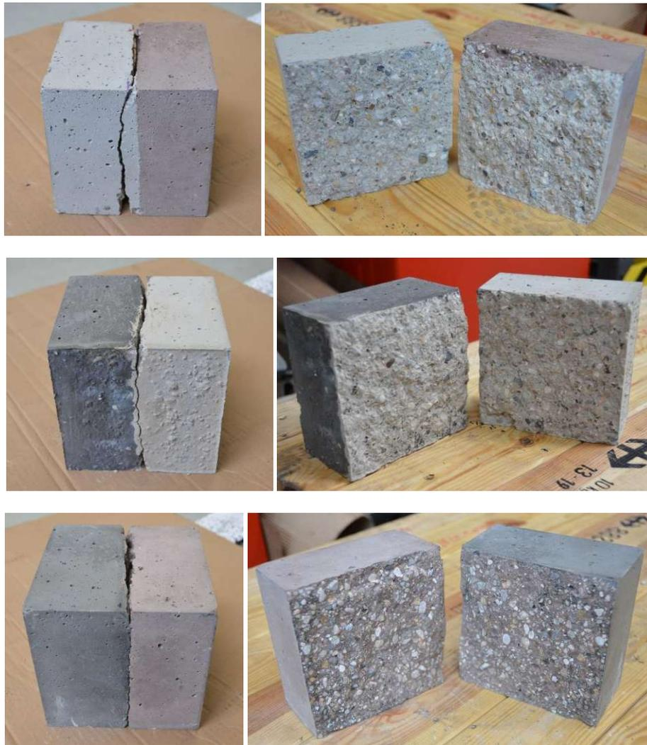
**Abb. 4.11:** Bruchflächen der Würfel, von oben nach unten: Ökobeton – mittelfester Beton, Ökobeton – hochfester Beton, mittelfester Beton – hochfester Beton
