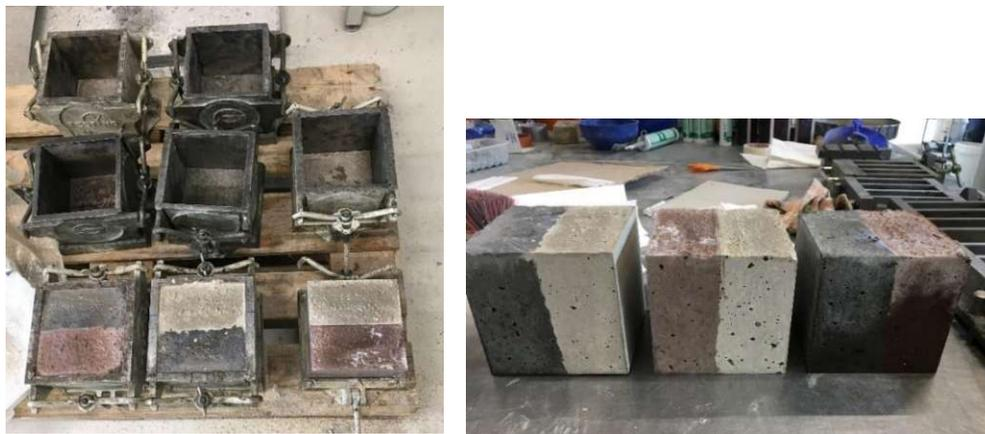
**Abb. 4.6:** Gradierte Betonwürfel in Schalkkörpern (links) und ausgeschalt (rechts)
