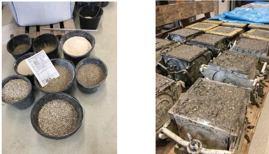
**Abb. 4.1:** Ausgangsstoffe der Mischung „low“ (links) und einfüllen der Betonmischungen in Schalkkörper
