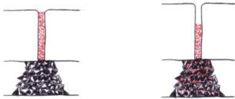
Abb. 2.20: Filterstabiles (li.) und nicht filterstabiles Material (re.) [15]
