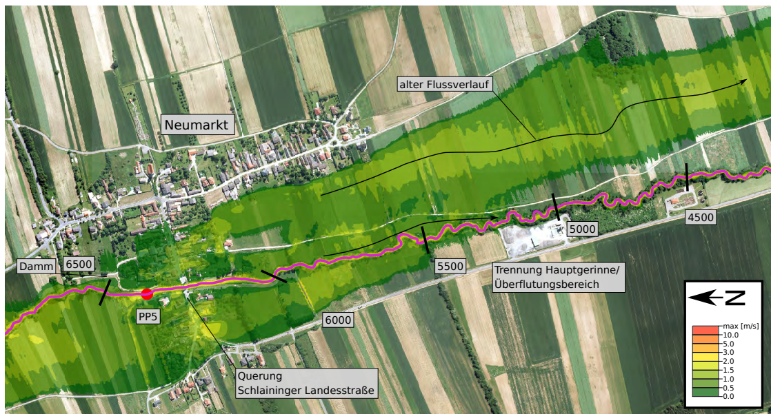
Abbildung 6.44: Maximale Strömungsgeschwindigkeiten im Bereich Neumarkt (PP5) - Flutwelle Smart
