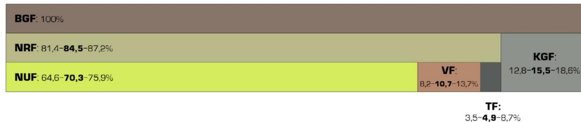
Abb. 224: Diagramm der Flächenermittlung
