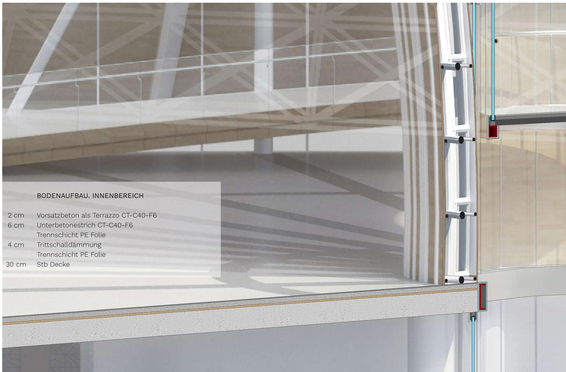
Abb. 199: 3d Fassadenschnitt. Detail 7
