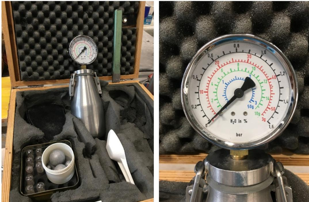
Abbildung 6: CM-Messgerät und Manometer
