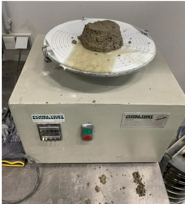
Abbildung 16: Versuch zur Bestimmung des Ausbreitmaßes
