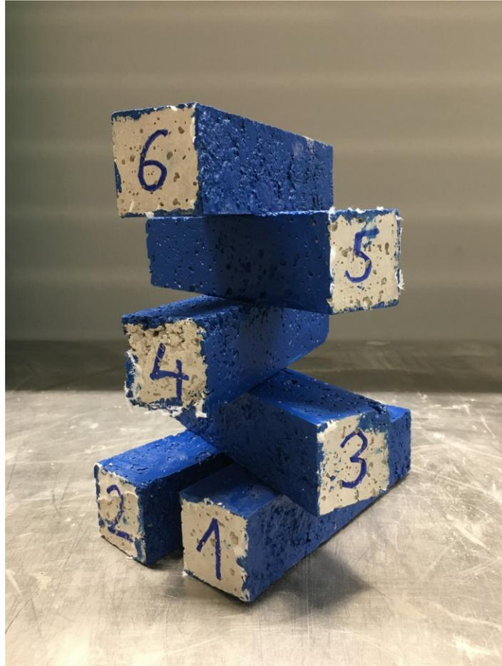
Abbildung 23: Beschichtete Prismen für den Saugversuch
