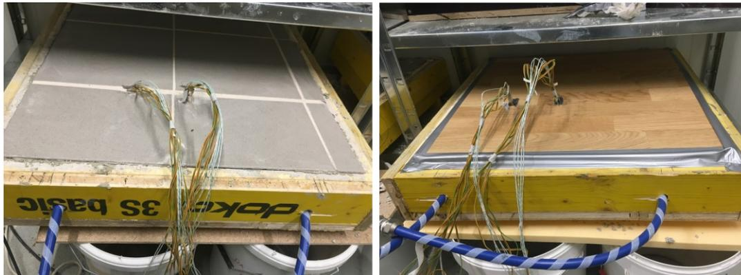
Abbildung 28: links: Probe 1 mit Fliesenbelag, rechts: Probe 2 mit Parkettbelag
