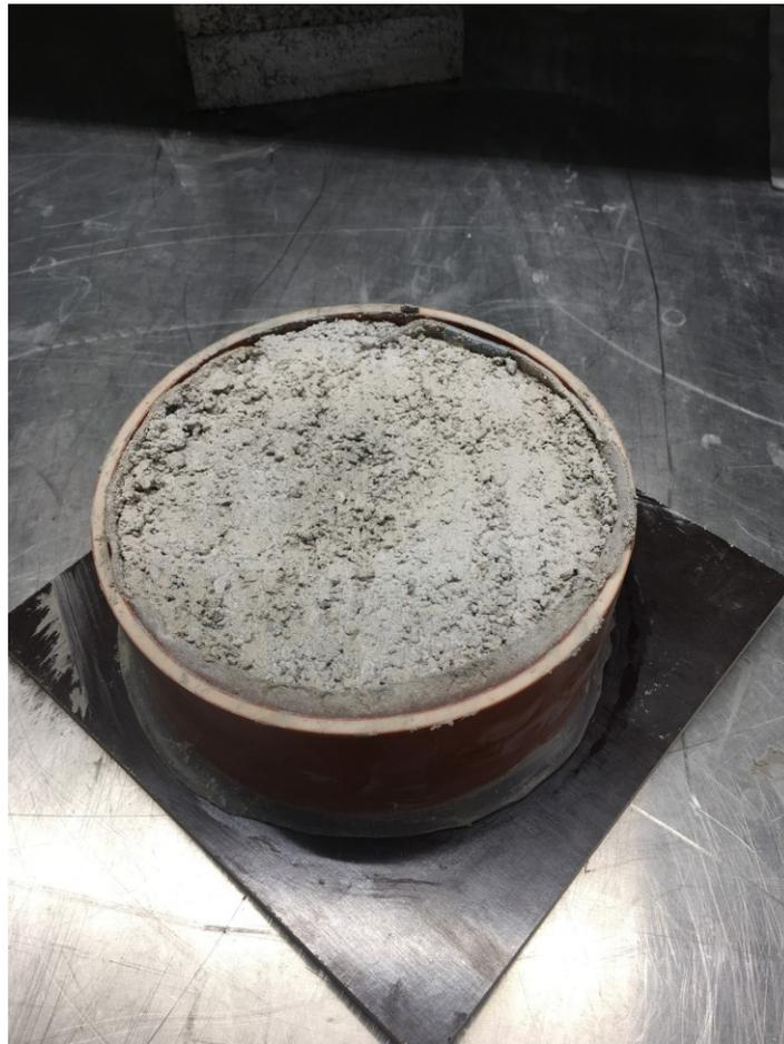
Abbildung 26: Probe für die Durchführung der CM-, Darr- und KRL-Messung
