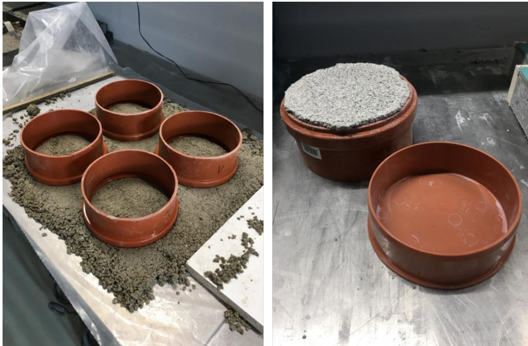
Abbildung 21: Probenherstellung zur Ermittlung des Wasserdampfdiffusionswiderstandes
