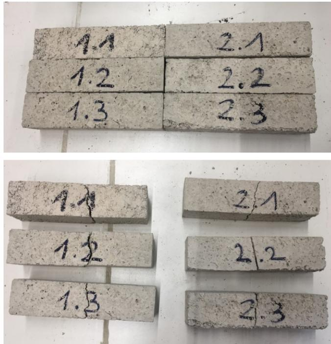
Abbildung 18: oben: Prismen vor Biegezugfestigkeitsprüfung, unten: Prismen nach Druckfestigkeitsprüfung
