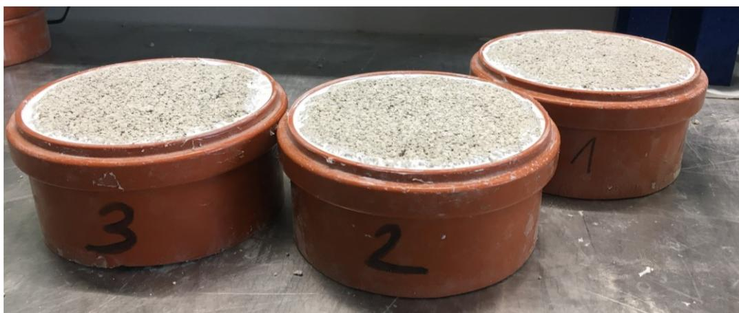
Abbildung 22: Fertige Proben zur Ermittlung des Wasserdampfdiffusionswiderstandes
