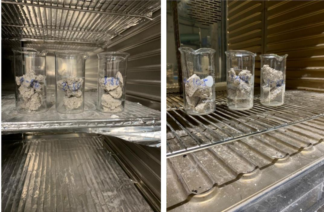
Abbildung 7: Darrvorgang im Zuge der Feuchtigkeitsmessung an der Probe Nr. 3
