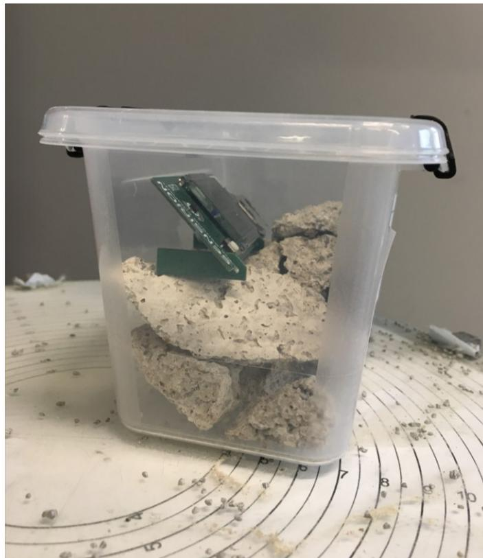
Abbildung 8: KRL Messung in einem Plastikbehälter an der Probe Nr. 3
