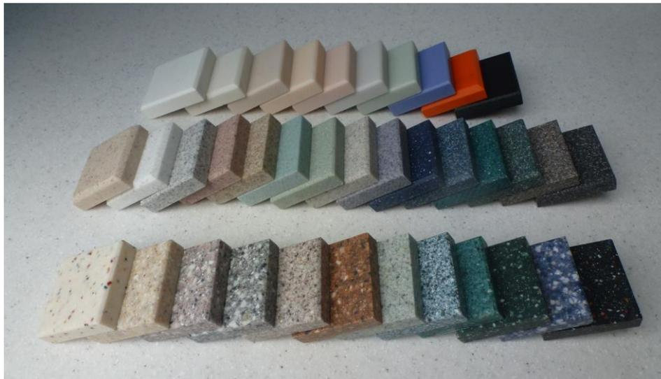
Abbildung 2.23 Verschiedene Muster- und Farbproben von Corian auf hellem Corian-Untergrund [11]
