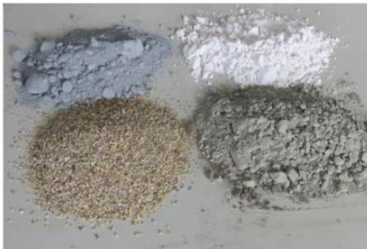
Abbildung 2.2 Bestandteile des UHPC [40]
