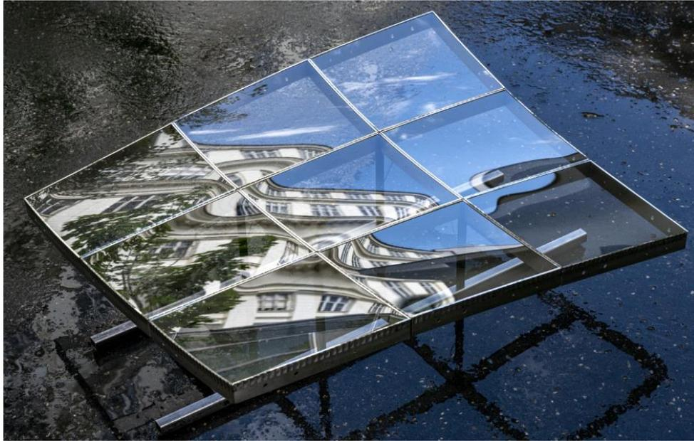
Abbildung 4.7 Herstellung einer doppelt gekrümmten Fläche mit 3x3 kalt gebogenen Platten zur Validation der Ergebnisse [37]
