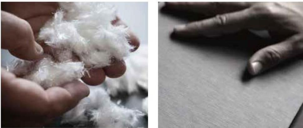
Abbildung 2.18 Zellstoff-Faser und Zementfaserplatte als Produkt [10]
