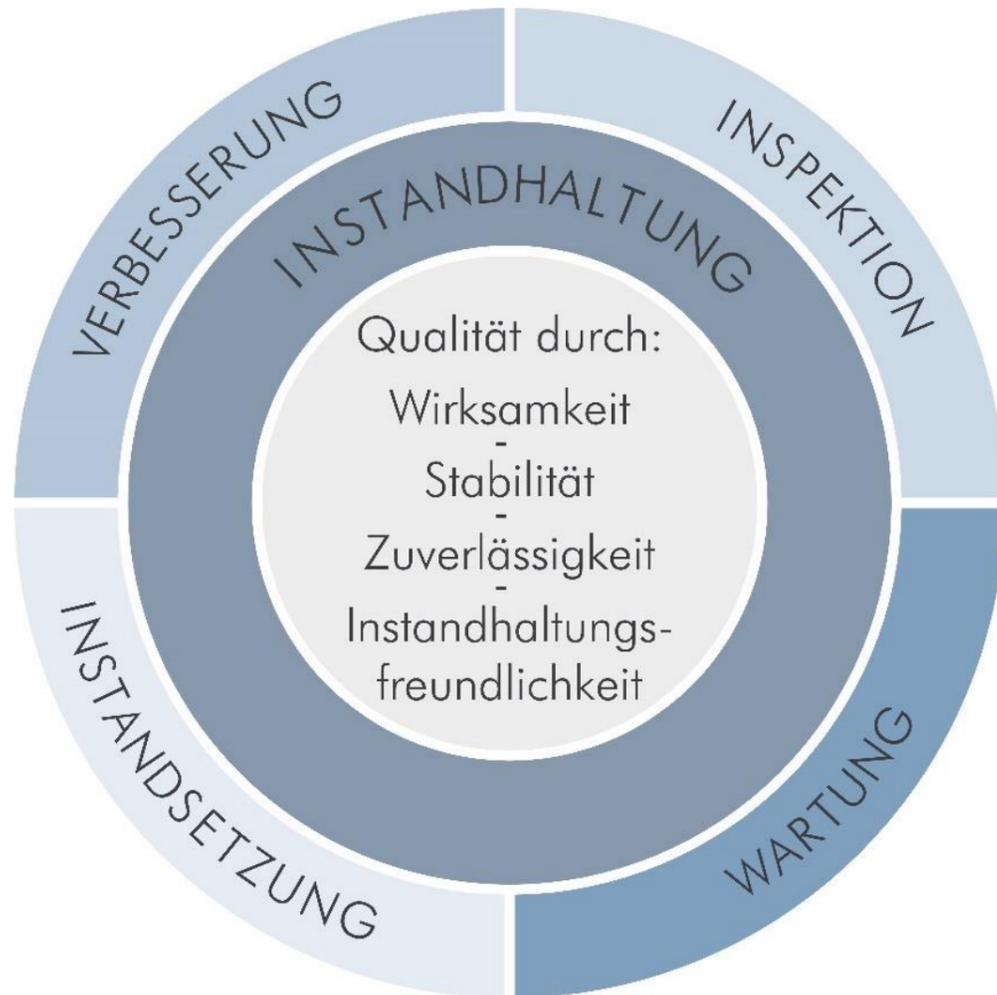
Abb. 3: Unterteilung der Instandhaltung, Quelle: Siemens
