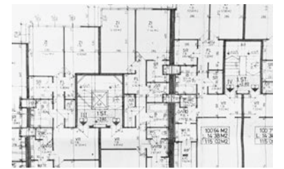
Abb. 332 Perforation durch Installationsschächte
