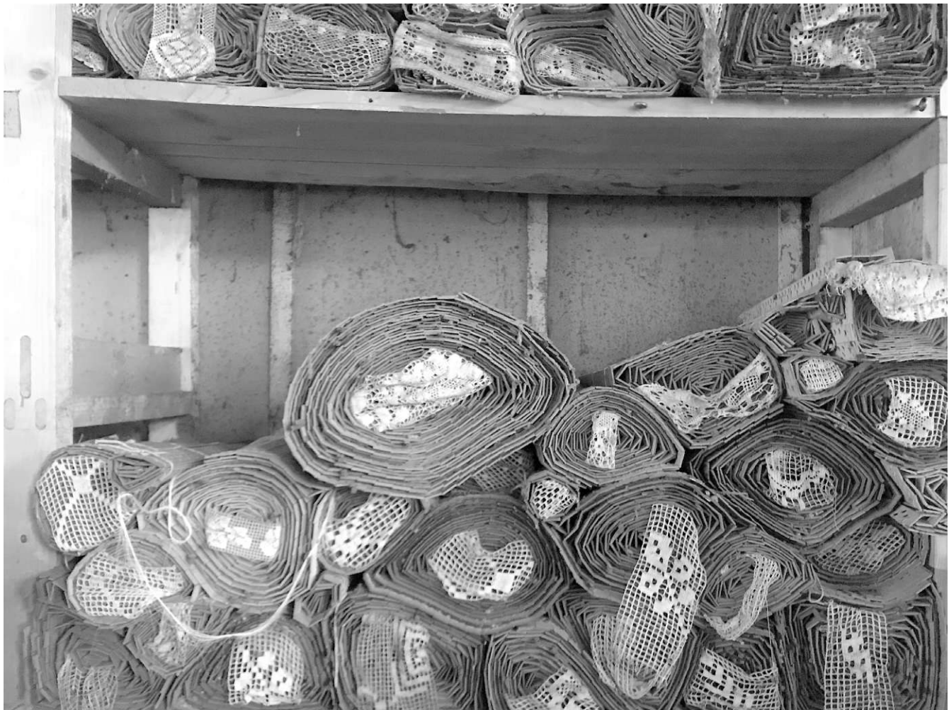
Abb. 76 Lochkartenrollen mit Klöpelspitzenmustern in der Fabrik Alexander Hesse 2019.
