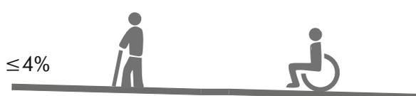
Die allgemeine Anforderungen an Rampen gelten bis einer Steigung von 4%. Bei einer Neigung von  $\leq 4\%$  wird die Rampe als eine geneigte Fläche betrachtet und muss laut ÖNorm B1600 keine Zwischenpodeste und Handläufe haben.
