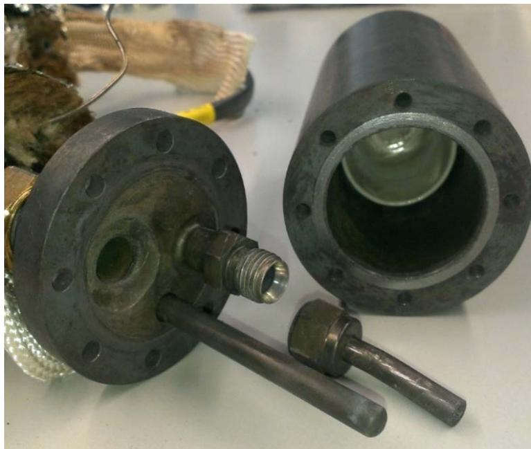
Abbildung 4: Kleiner Verdampfungsreaktor mit Graphitdichtung, Fall- & Blindrohr - M. Lessiak [5]
