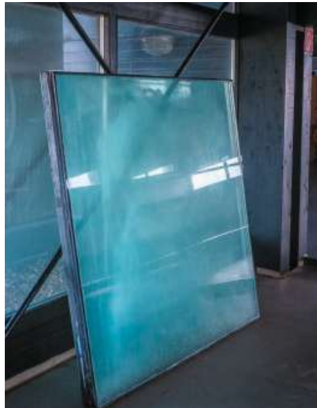
Abb. 108 – Trübes Glaselement, im Profil sind drei Glasscheiben ersichtlich
