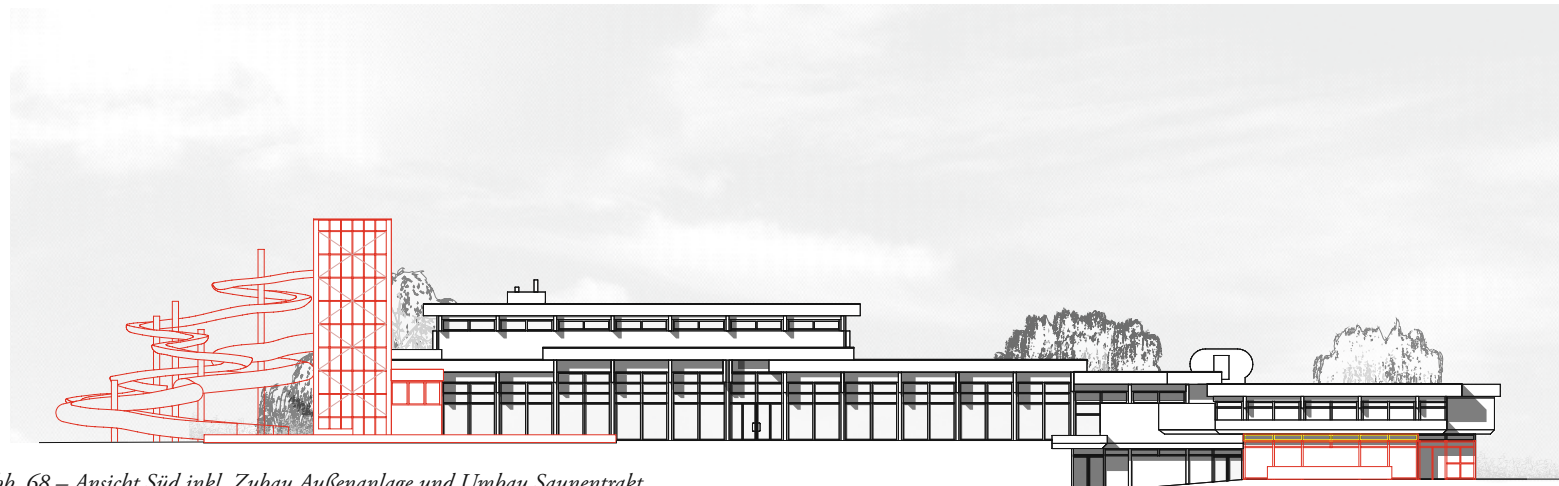
Abb. 68 – Ansicht Süd inkl. Zubau Außenanlage und Umbau Saunentrakt
