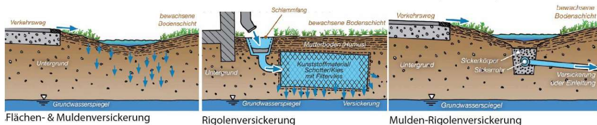
Abbildung 27: Grafikskeizze zu Fläche- & Mulden-; Rogolen-; und Mulden-Rigolenversickerung
