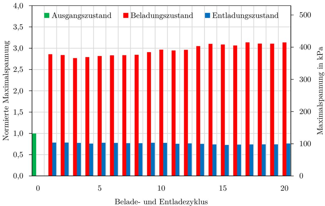
Abbildung 11-4 Spannungsverlauf mehrerer Belade- und Entladezyklen bei VW00
