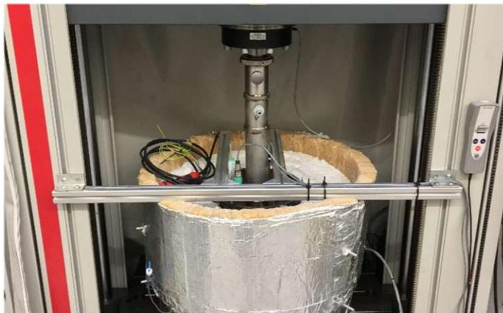
Abbildung 9-12 Druckversuch in der Universal-Zug/Druck-Prüfmaschine
