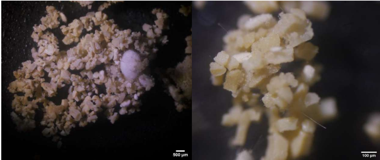
Abbildung 20: Rückstand (TMT-Zersetzungsprodukt) thermische Behandlung \text{Hg}_3\text{TMT}_2 (Versuch 1) unter dem Lichtmikroskop, eigene Aufnahme
