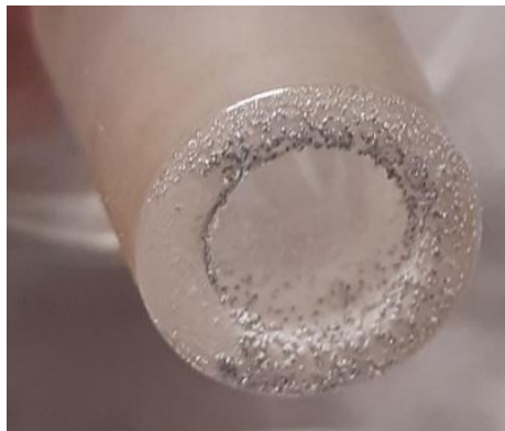
Abbildung 29: Metallisches Quecksilber am Sublimationskolben nach thermischer Behandlung des Hydroxidfällungsproduktes, eigene Aufnahme
