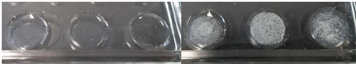
Abbildung 22: Nachweisreaktion von Schwefel als \text{BaSO}_4 , vor (li.) und nach (re.) Zugabe \text{BaCl}_2 , eigene Aufnahme
