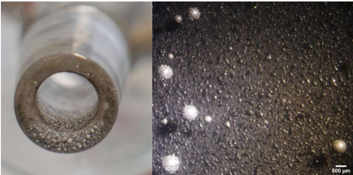
Abbildung 33: Metallisches Quecksilber nach thermischer Behandlung von \text{Hg}_3\text{TMT}_2 -Filterkuchen-Mischung an Sublimationskolben (li.) und unter dem Lichtmikroskop (re.), eigene Aufnahme
