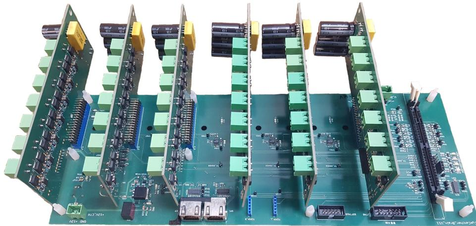
**Abbildung 3.5:** Zusammenbau des Motherboards und der Leistungselektronik Platine.
