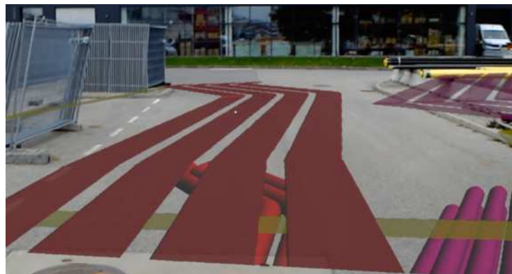
Abb. 50: HoloLens-Darstellung der unterirdischen Leitungsinfrastruktur (wienersstadtwerke.at)
