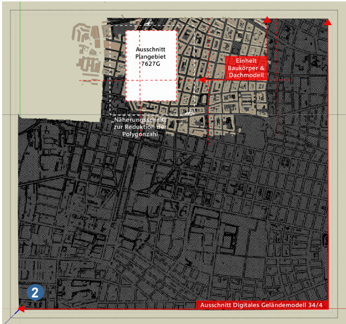
Abb. 69: Kombination, Ausrichtung und Beschnitt der Daten in SketchUp Pro (eigene Darstellung)
