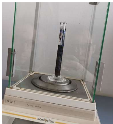
Abbildung 23: Versuchsaufbau für die Dichtebestimmung des Beizschlammes
