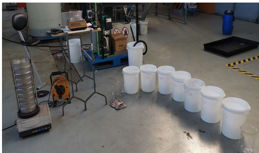
Abbildung 43: Versuchsaufbau Siebung, Siebturm, Waage und Fraktionsbehälter
