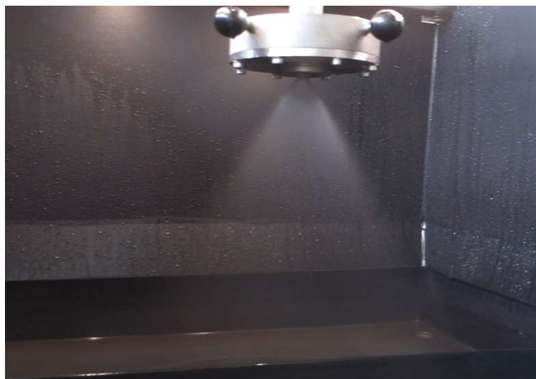
Abbildung 54: Sprühbild mit 255 g/L Zunder
