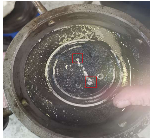
(b) Mit Zunder verstopfter Düsenstock
