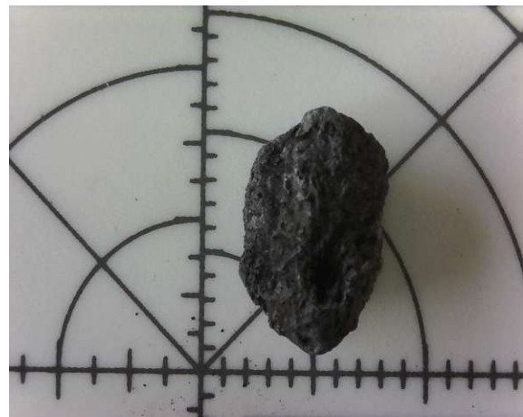
Abbildung 40: Eflex: 4 mm Fraktion
