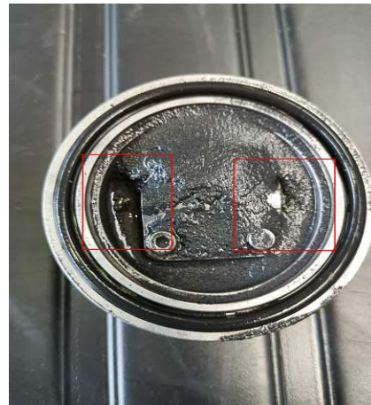
(b) Düsenstock nach 5 min Sprühzeit
