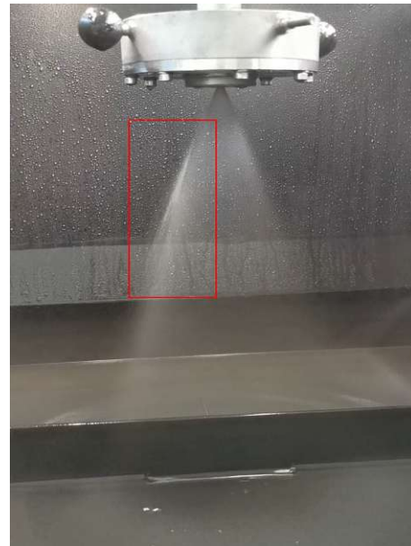
(b) instabiles Sprühbild
