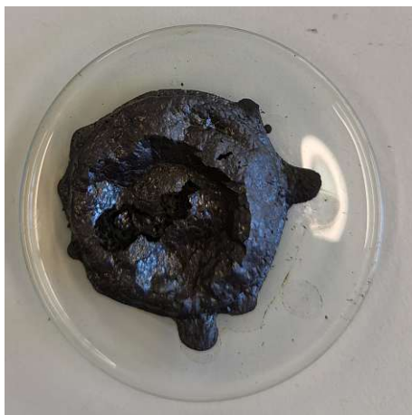
(a) Agglomerierter Beizschlamm
