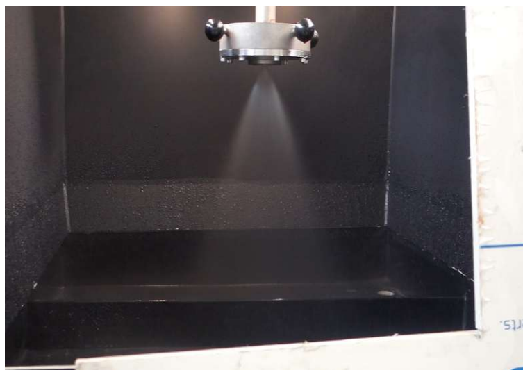
Abbildung 48: Sprühbild mit 25 g/L Zunder
