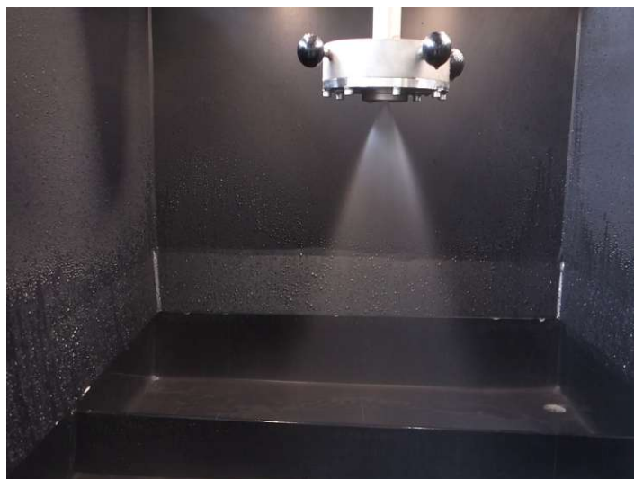
Abbildung 49: Sprühbild mit 85 g/L Zunder
