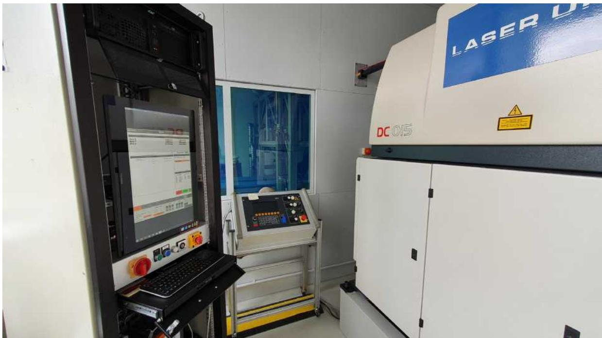
Abbildung 2.1.: Übersicht der Anlage. V.l.n.r.: Bedienpanel CNC-Verfahrenanlage, Bedienpanel Laser, Laser
