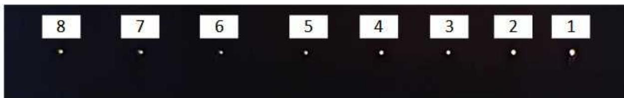
Abbildung 3.5.: Einstiche in 1mm Edelstahlblech mit unterschiedlichen Fokusabständen
