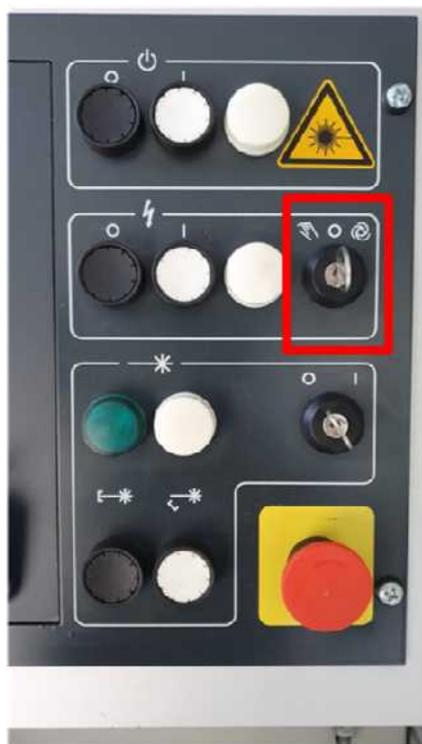
Abbildung 2.25.: Ansicht des Laserpanels mit rot markiertem „Schlüsselschalter“
