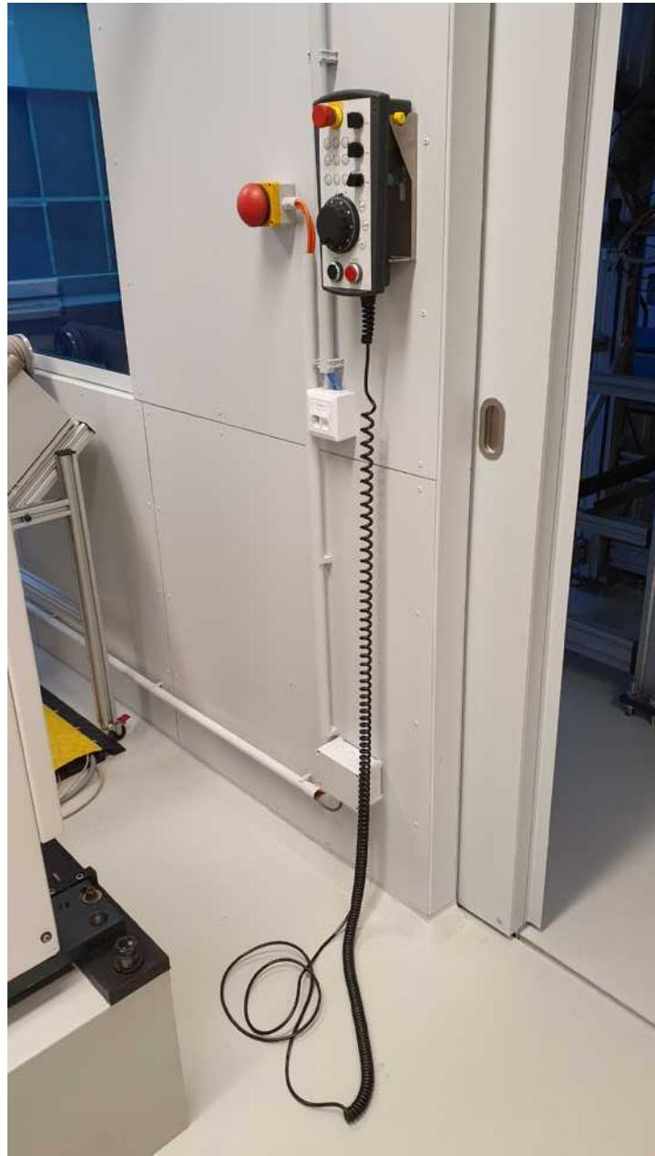
Abbildung 2.21.: Neue Position des Handbediengeräts mit nebenliegendem, neuem Not-Aus-Taster
