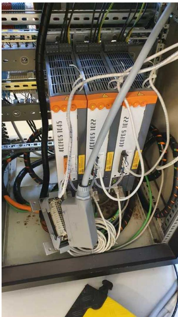
Abbildung 2.5.: Vorderseite des beweglichen Schaltschranks der SPS der CNC-Verfahrenanlage
