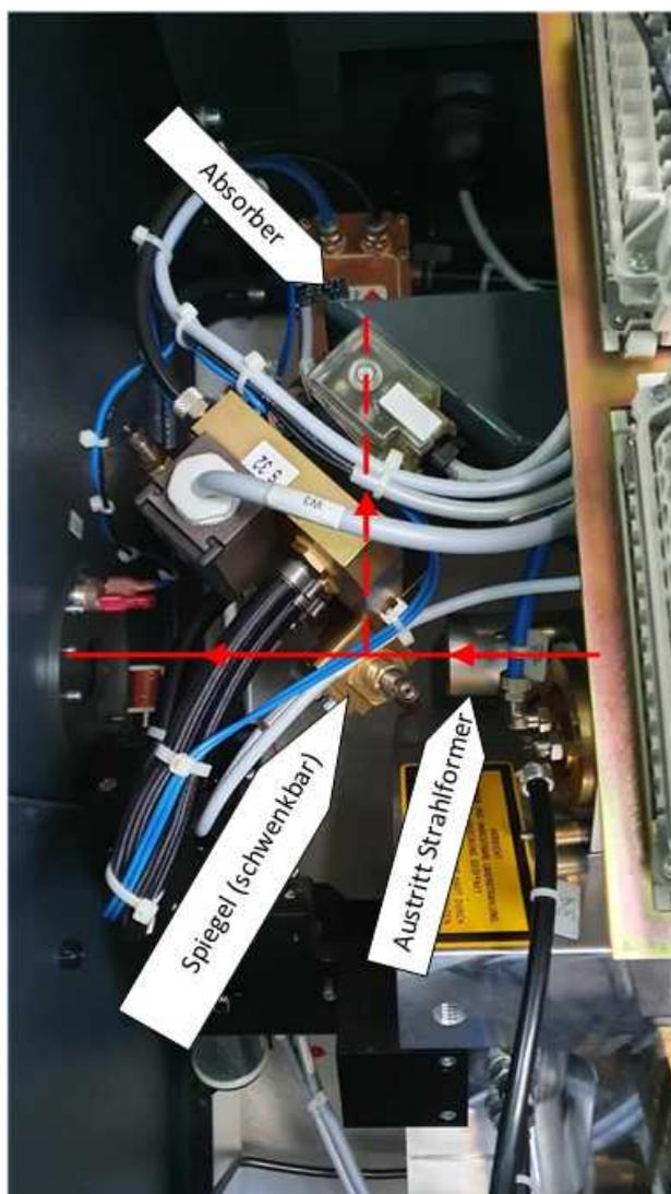
Abbildung 3.2.: Verschluss und Absorber
