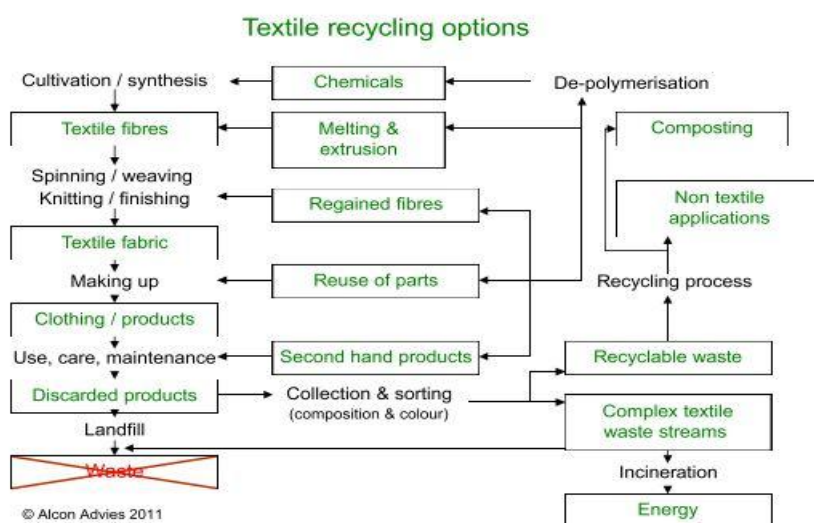
Abbildung 2: Verfahrensschritte bei der Textilproduktion und bei verschiedenen Recyclingmethoden [6]
