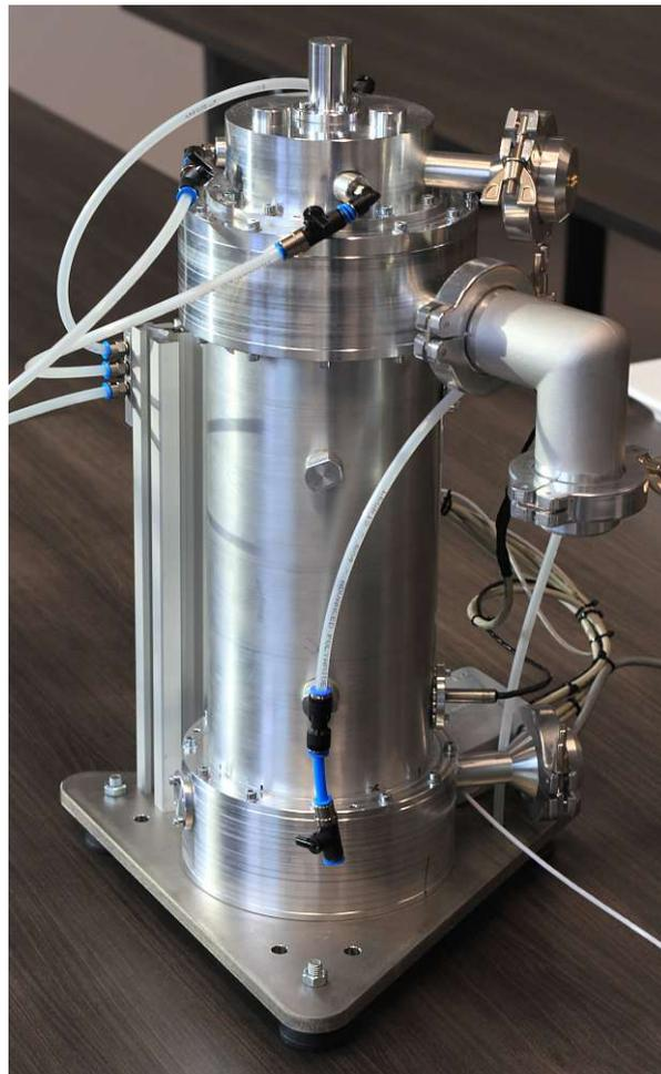
Abbildung 8.5 Gesamter Testaufbau des Reluktanzmagnetlagers
