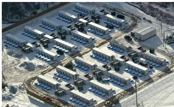
**Abbildung 1.5** 20 MW Anlage bestehend aus 200 kleineren Schwungradspeichern zur Netzstabilisierung in New York, USA. (Bildquelle: [26]).
