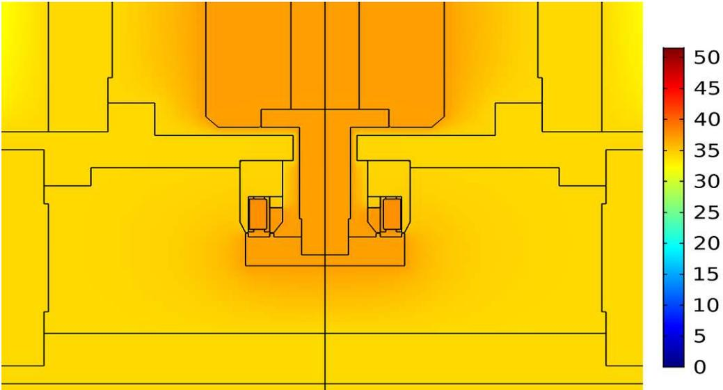
**Abbildung 5.18** Temperaturverteilung des unteren Lagers/ $\Delta T$  in Relation zur Umgebungstemperatur ( $20^{\circ}\text{C}$ ), bei  $I=0.8\text{ A}$
