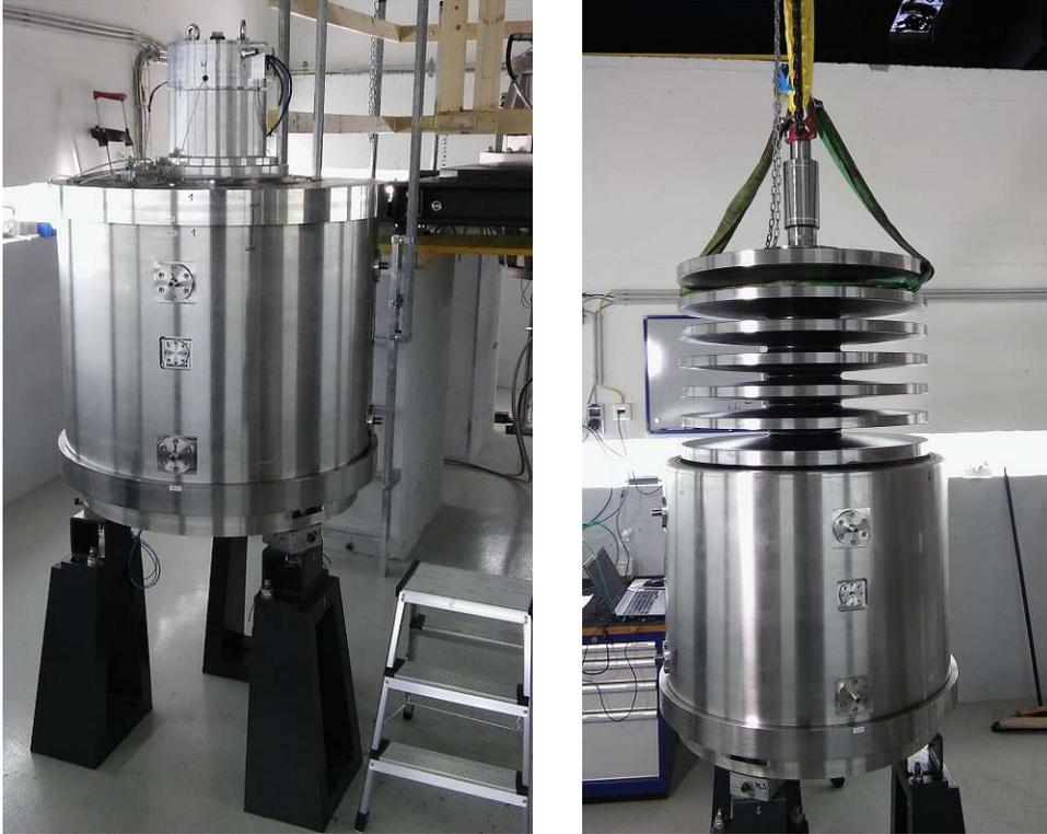
**Abbildung 9.1** *Flywheel-Prototyp mit selbstzentrierendem homopolarem Reluktanzlager. Kaskadierte Rotorgeometrie zur Reduzierung der Spannungen im Bereich der Rotationsachse (Bildquelle: IFT)*
