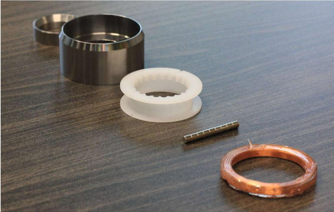
Abbildung 4.4 *Komponenten des Magnetlagers vor dem Zusammenbau.*
