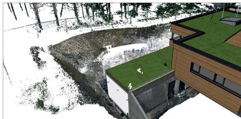
Darstellung des virtuellen Modells referenziert im Gelände (aus den Daten der aufgenommenen Punktwolke).
