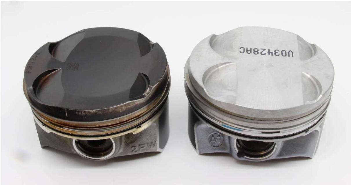
Abbildung 39: Versuchskolben mit Serienverdichtungsverhältnis  $\varepsilon = 12,5$  (links) und erhöhtem Verdichtungsverhältnis  $\varepsilon = 13,3$  (rechts).
