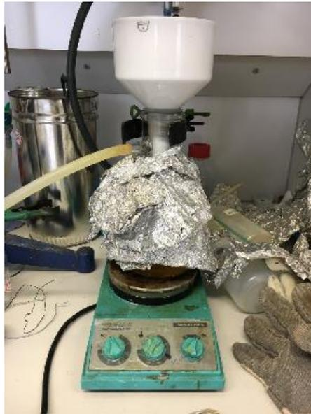
**Abbildung 31: Versuchsdurchführung der Heißfiltration**
