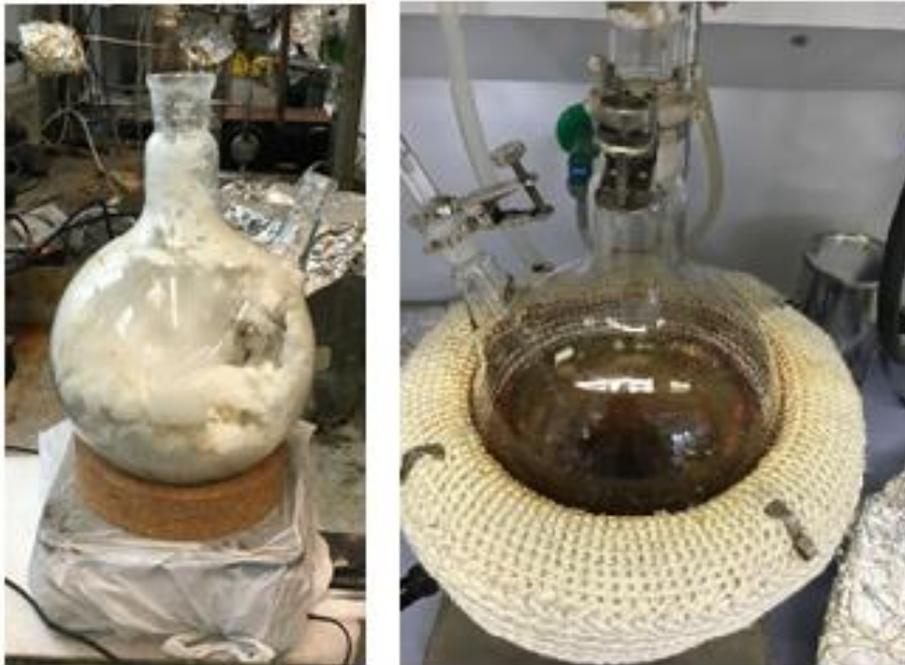
Abbildung 21: festes Rohwachs nach der Befüllung des Kolbens, und in flüssiger Form nach der Vakuumdestillation
