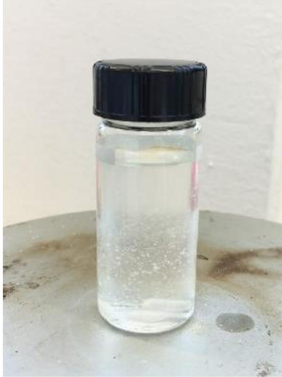
**Abbildung 27: Schwebende Wachspartikel bei der Vermischung mit Lösungsmittel**
