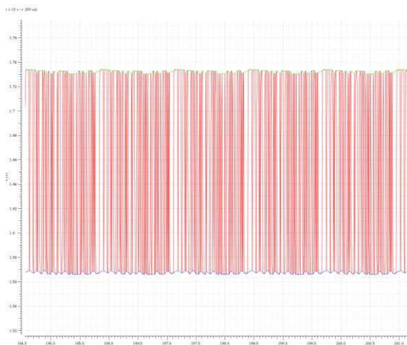
Abbildung 3-10 Zeitlicher Verlauf am Ausgang des Differentiators U_{dif\_out} im eingeschwungenen Zustand der Schaltungsvariante mit der PMOS-Konstantstromquelle bei 2 nA mittlerem Photostroms mit einem Bias-Strom von 4 nA
