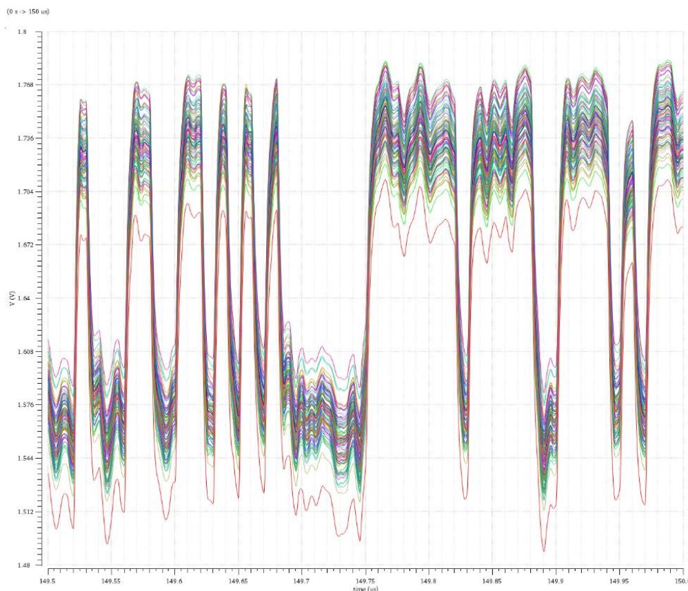
Abbildung 3-22 - Spannung am Ausgang des Differentiators u_{dif\_out} inklusive transientem Rauschen in der Schaltungsvariante mit der PMOS-Konstantstromquelle für 100 Monte-Carlo-Simulationen
