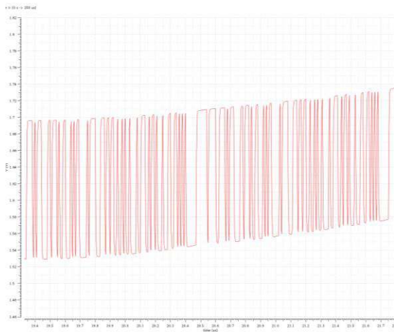
Abbildung 3-8 Einschwingen der Schaltungsvariante mit der PMOS-Konstantstromquelle am Ausgang des Differentiators U_{dif\_out} , bei 2 nA Photostrom mit einem Bias-Strom von 4 nA; vergrößerte Darstellung von Abbildung 3-6
