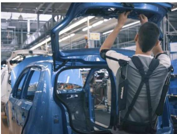
Abbildung 38: Überkopf-Montage Volkswagen <sup>216</sup>
