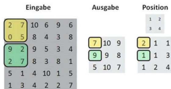
Abbildung 13 | Maximal-Pooling mit Pooling-Faktor 2 [25]
