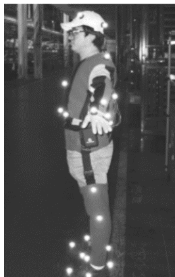
Abbildung 4 | Motion Capture-Anzug mit Markierungen an den Hauptgelenken [4]
