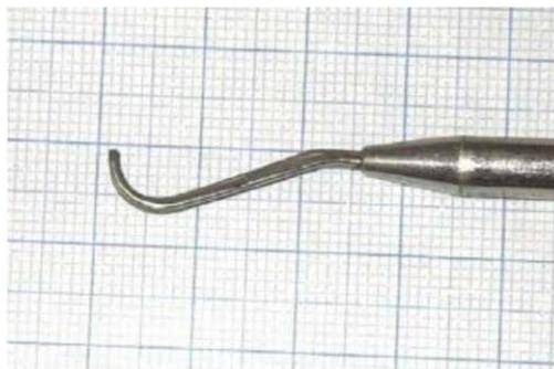
Abbildung 17 Detailansicht SVUSS/3 Kobrasondenkopf [6]
