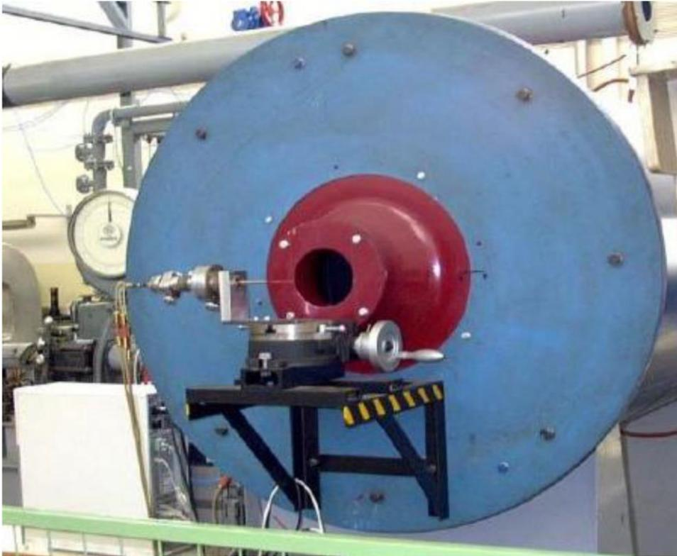
Abbildung 25 Einspannung der Dreilochsonde vor der Düse für die Kalibrierung [8]
