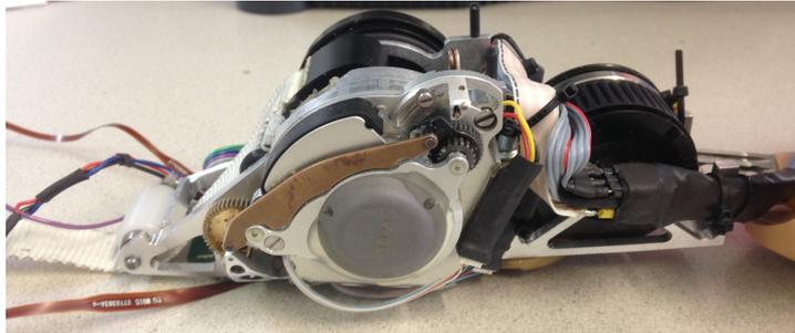
Abbildung 1.3: komplett aufgebaute Liftereinheit
