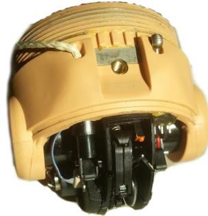
Abbildung 4.2: Gelenkskugel mit Sperre ( Gehäuse geöffnet)
