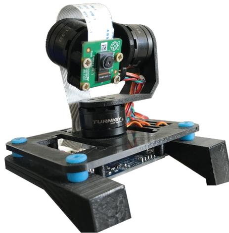
Abbildung 4.5: Aufbau des Kamerasystems
