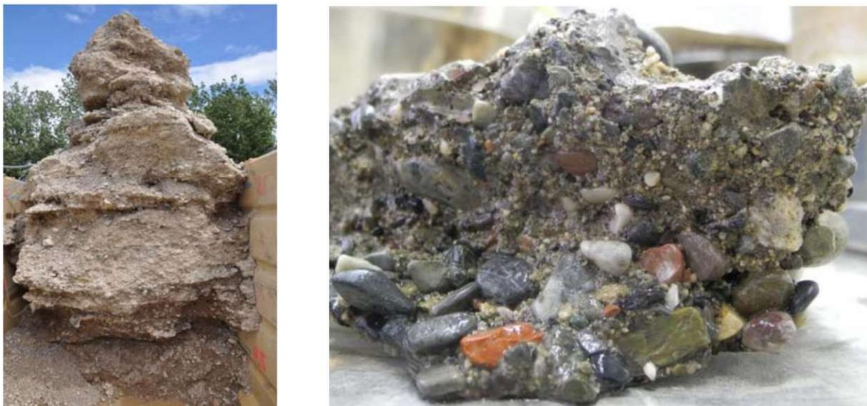
**Abb. 2.9:** Links: Freigelegter Injektionskörper Rechts: Injektionskörperprobe [5]
