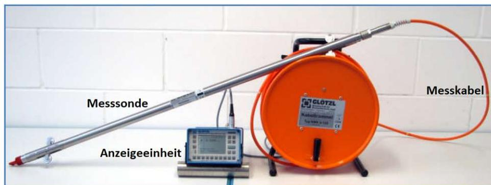
Abb. 2.26: Aufbau eines Inklinometers [12]
