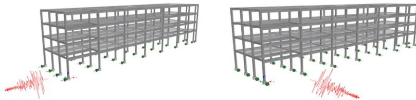
Abb. 7.8: Aufgebrachtes Akzelerogramm in X- und Y-Richtung
