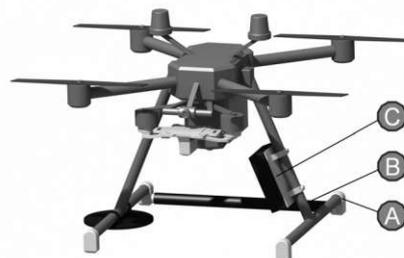
**Abbildung 59: Befestigungsvorrichtung für die Querstrebe (eigene Darstellung)**
