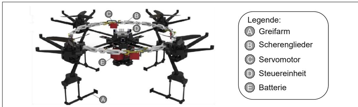
**Abbildung 24: Greifmechanismus mit Scherengliedern (eigene Darstellung in Anlehnung an Zhao et al. 2022, S. 4)**
