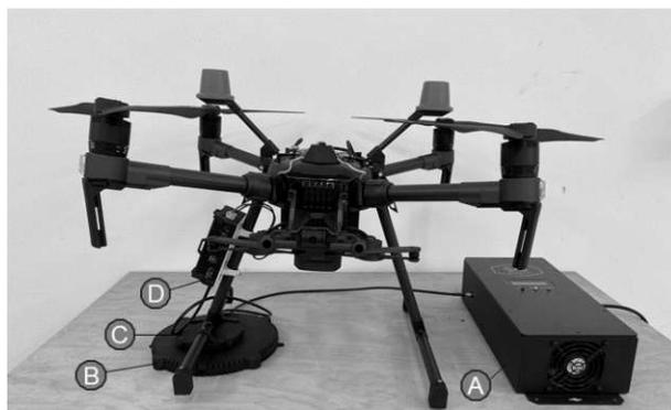
**Abbildung 52: Systembauteile induktive Ladeeinheit (eigene Darstellung)**
