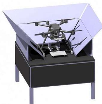
**Abbildung 64: Erweiterungselemente für die Gleitflächen (eigene Darstellung)**
