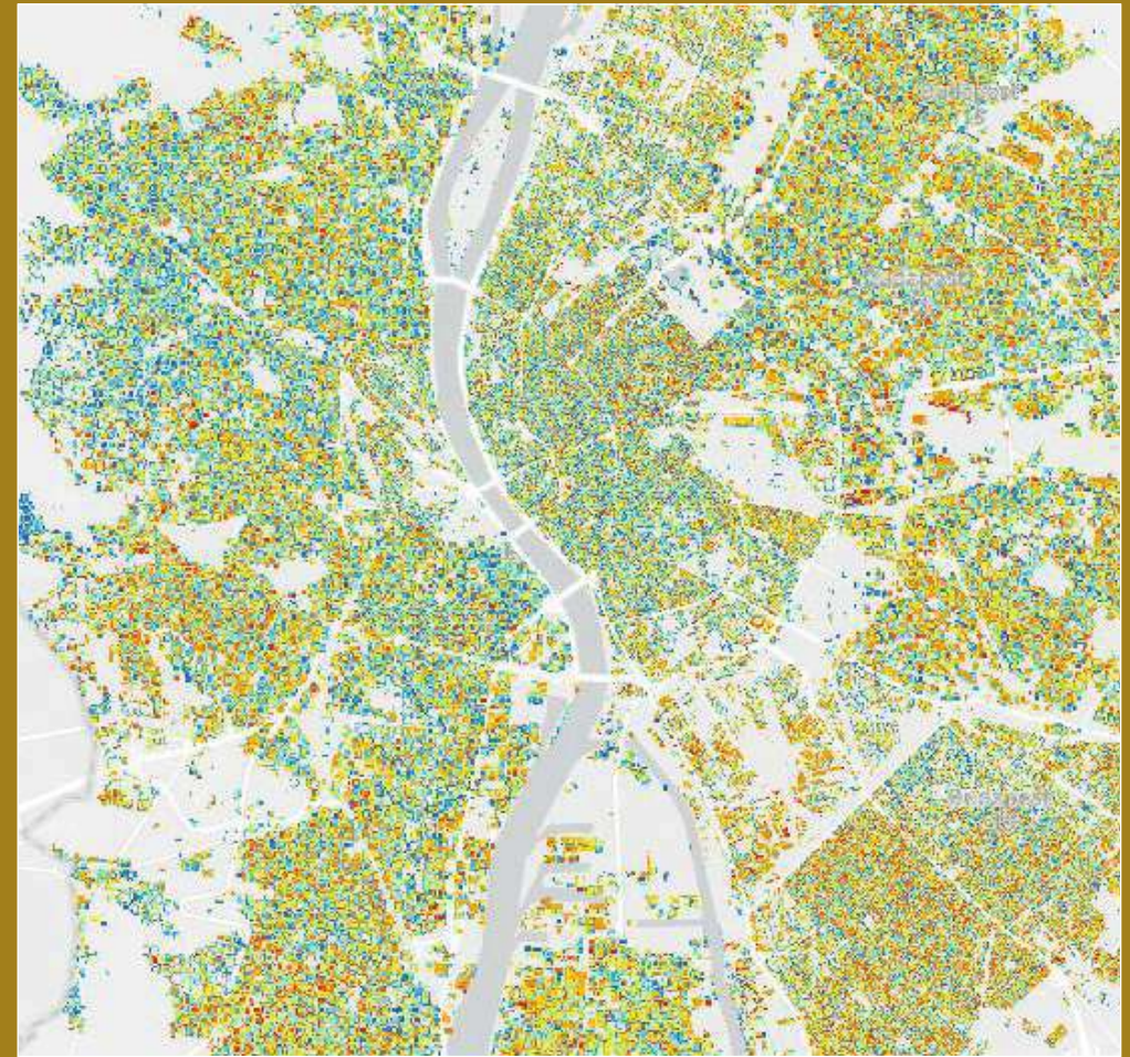
Abb.2.22 Solare Einstrahlung - (un-)günstige Dachflächen zur Nutzung von Sonnenenergie
