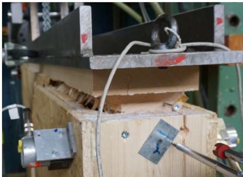
**Abb. 1.13:** Ablösen des Rähms im Belastungsversuch V2.2 [4]
