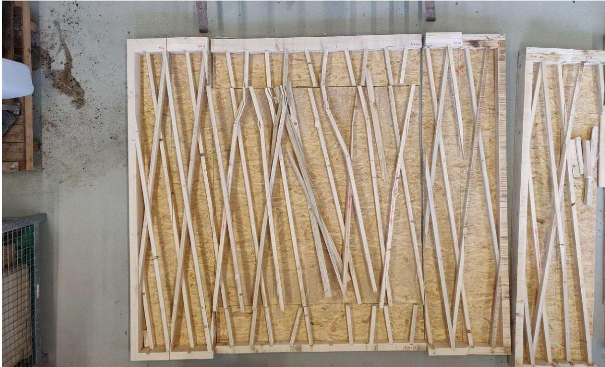
Abb. 1.8: Knickversagen Innenlamellen
