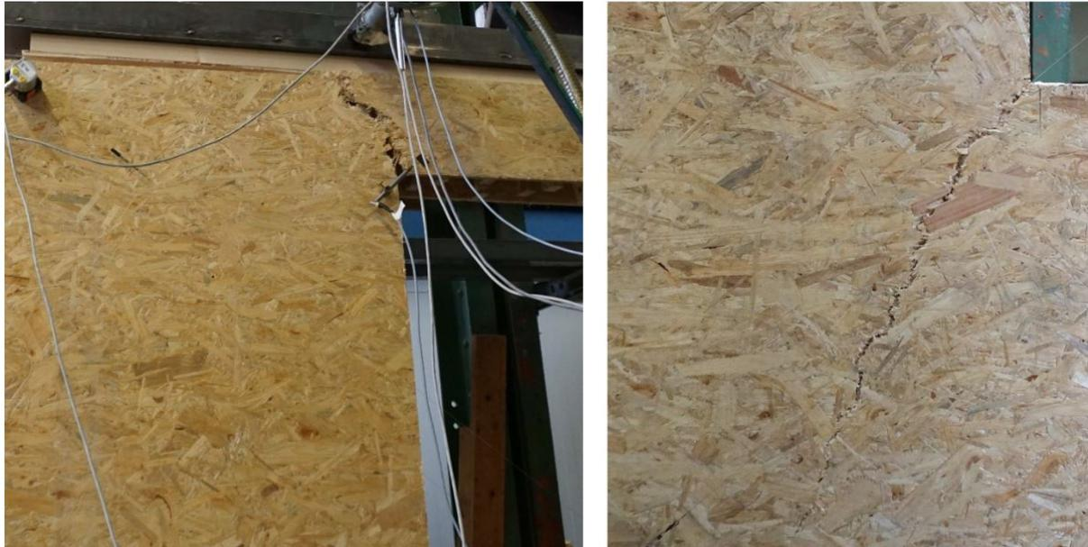
**Abb. 1.12:** Risse in OSB Beplankung im Belastungsversuch V2.2 [4]
