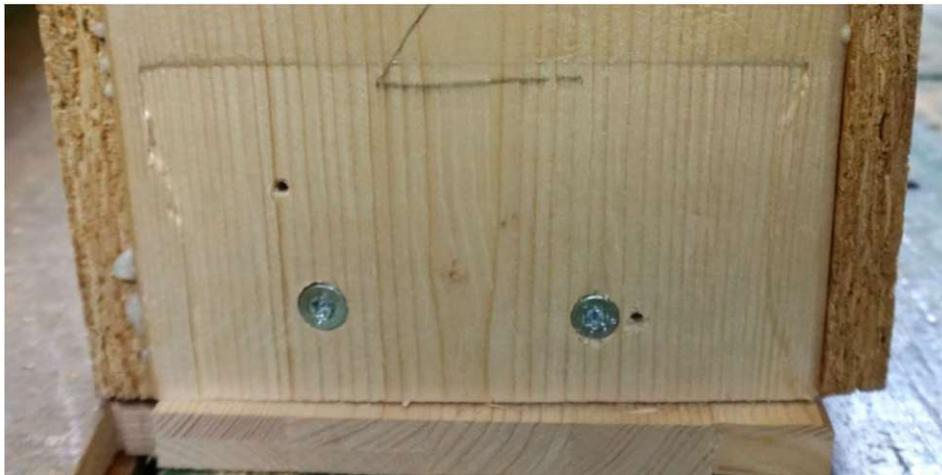
Abb. 3.28: Darstellung der Lagerung der unteren Schwelle im Belastungsversuch [4]
