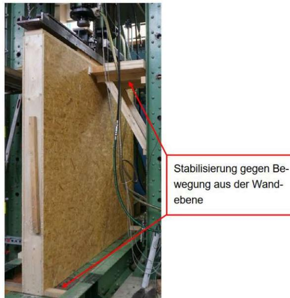
Abb. 3.35: Lagesicherung des Versuchskörpers gegen seitliches Ausweichen [4]
