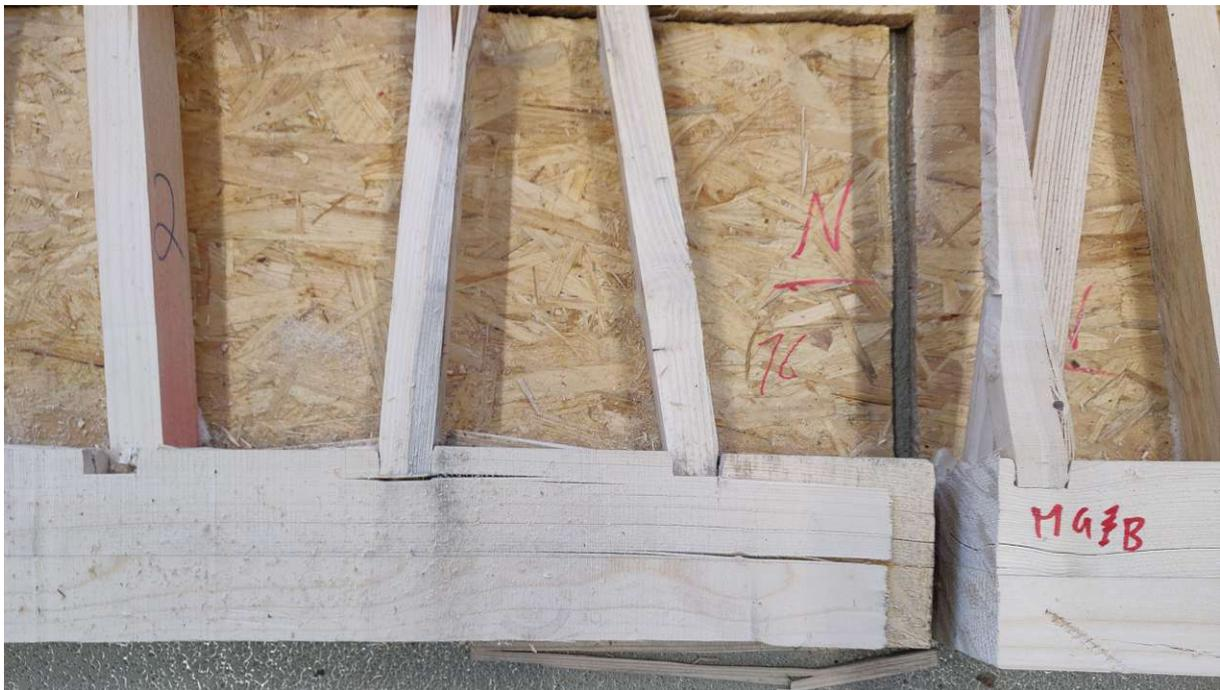
Abb. 1.9: Quersugversagen Schwelle
