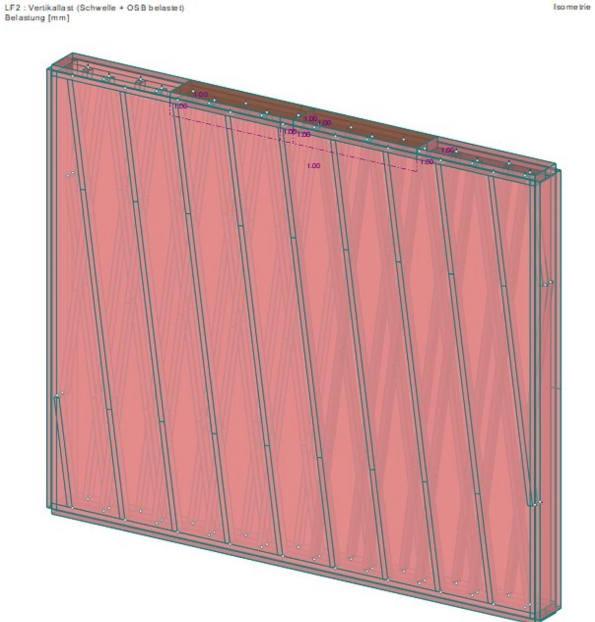
**Abb. 3.82:** Darstellung der Mitbelastung der OSB Beplankung der Variante mit Mittelebene
