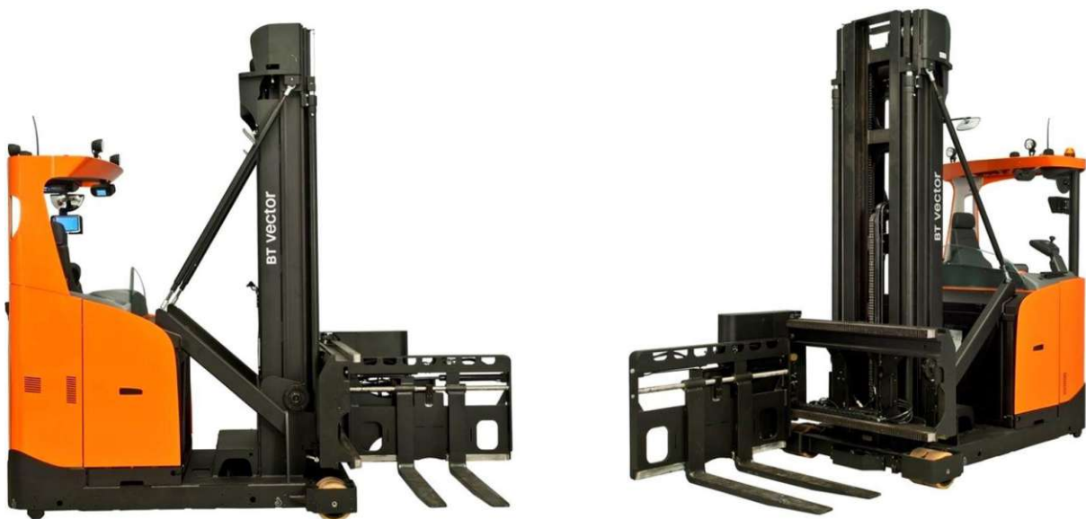
Abbildung 13: Schmalgangstapler in zwei Ansichten (Dreiseitenausführung) [14]
