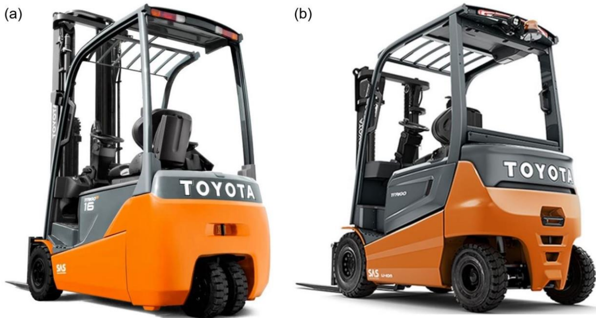
Abbildung 11: Frontgabelstapler mit (a) Dreirad- [10] und (b) Vierradfahrgewerk [11]
