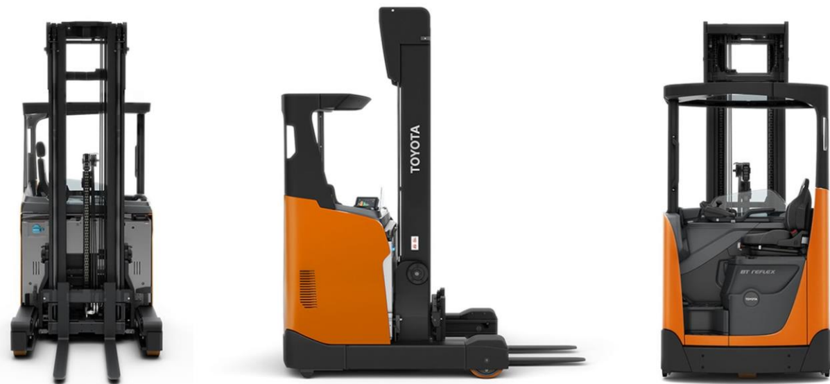
Abbildung 12: Schubmaststapler in drei Ansichten [13]
