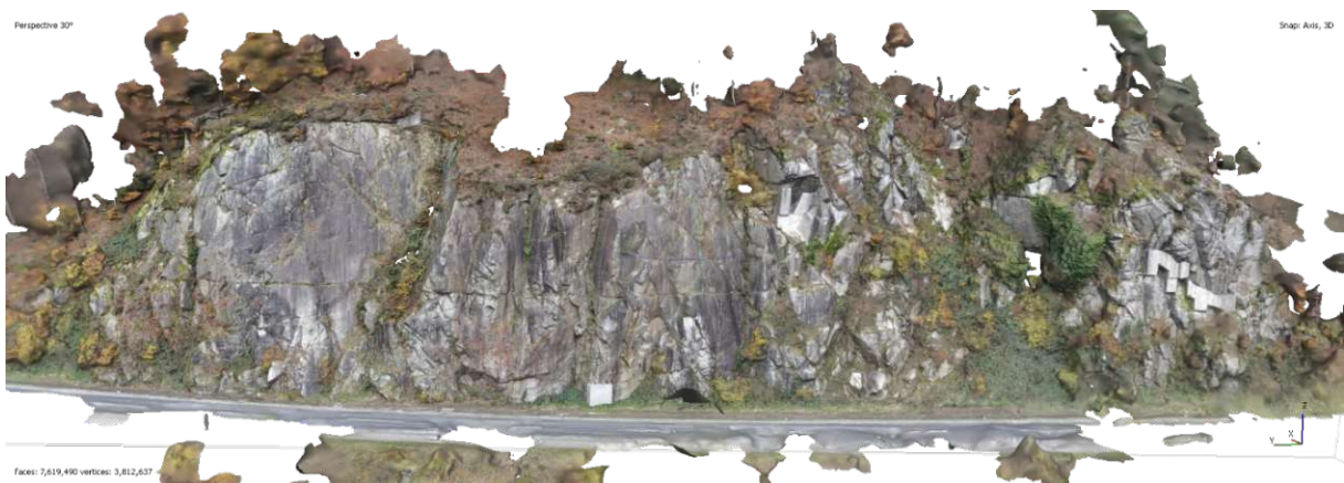
Abb. 5.4: Mit Agisoft Metashape erstellte Fotogrammetrie aus 55 Fotos der Art wie Abb. 5.1 und Abb. 5.3. Quelle: NÖ KSG
