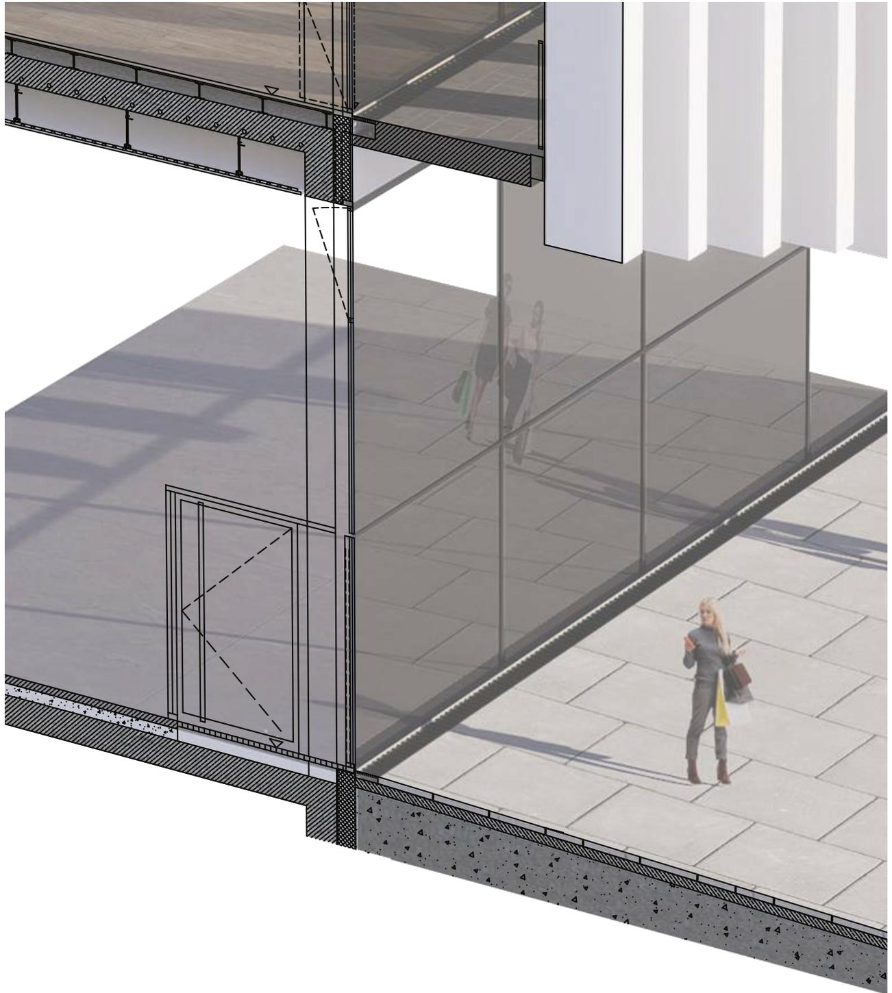
Abb. 76: Detailfassadenschnitt Erdgeschoßebene
