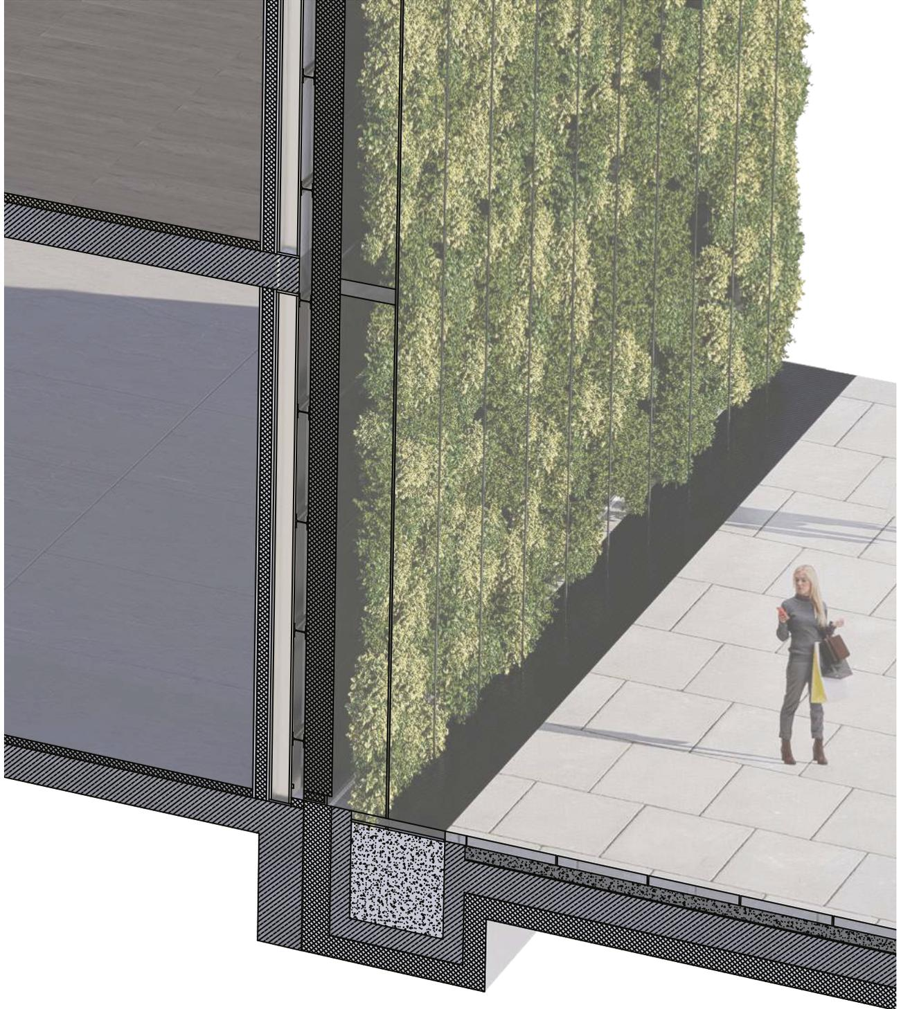
Abb. 79: Detailfassadenschnitt Erdgeschoßebene
