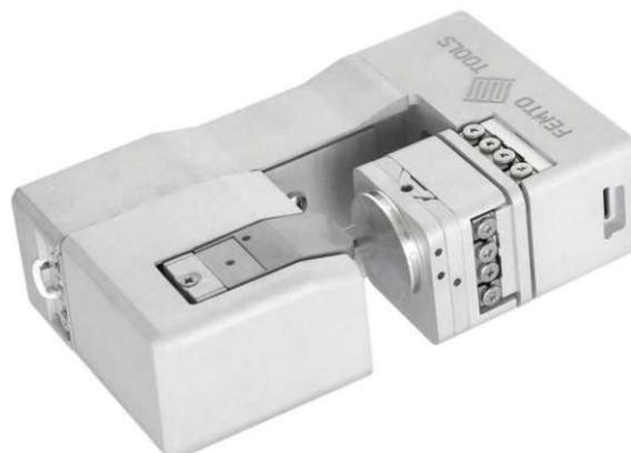
Abbildung 18: Nanohärteprüfeinrichtung für SEM
