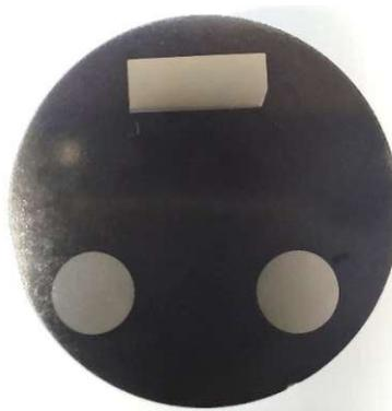
Abbildung 13: Position und Anordnung der Probe und von Wälzlagerkugeln in der Einbettung, diese dienen als „Stützen“ für eine gerade Schliffoberfläche
